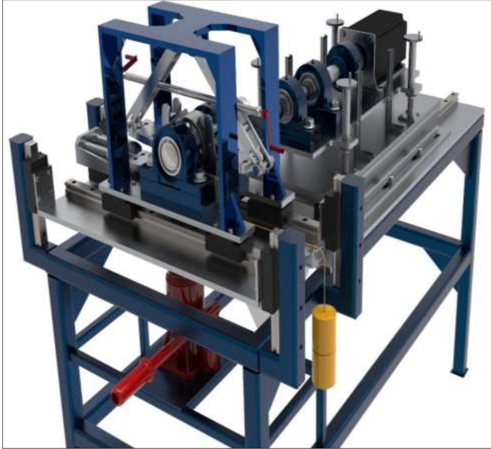
Şekil 5.1. Tasarlanan ikiz disk test cihazının Render görüntüsü-1.
