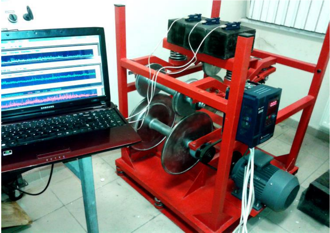
Şekil 2.3. 1/5 Ölçekli boji test ünitesi [8].
