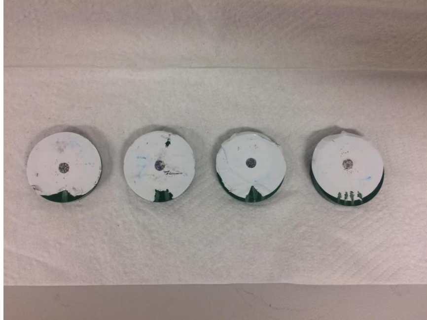
Şekil 5.11. Korozyon sonrası numune görüntüleri.
