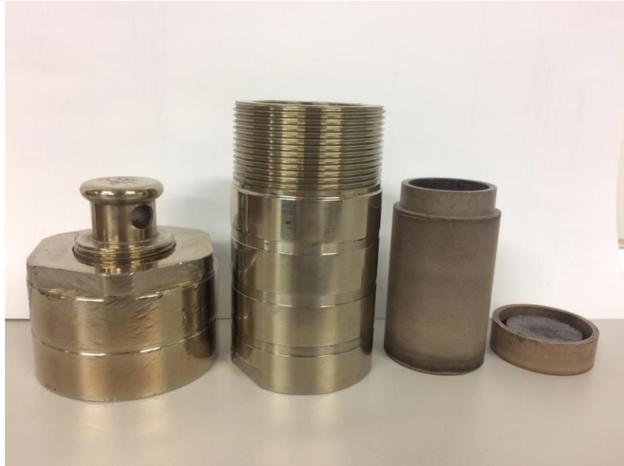
Şekil 4.1. Çalışmalarda kullanılan Teflon içlikli otoklav.
