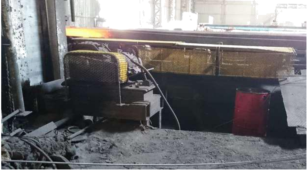
Şekil 4.14. Kayış kasnak sisteminin koruyucu muhafazası
