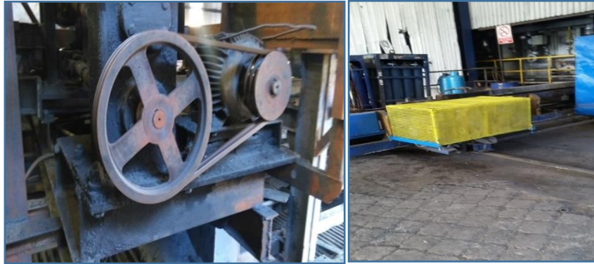
Şekil 4.21. Döner ve hareketli kısımlarda koruyucu muhafaza
