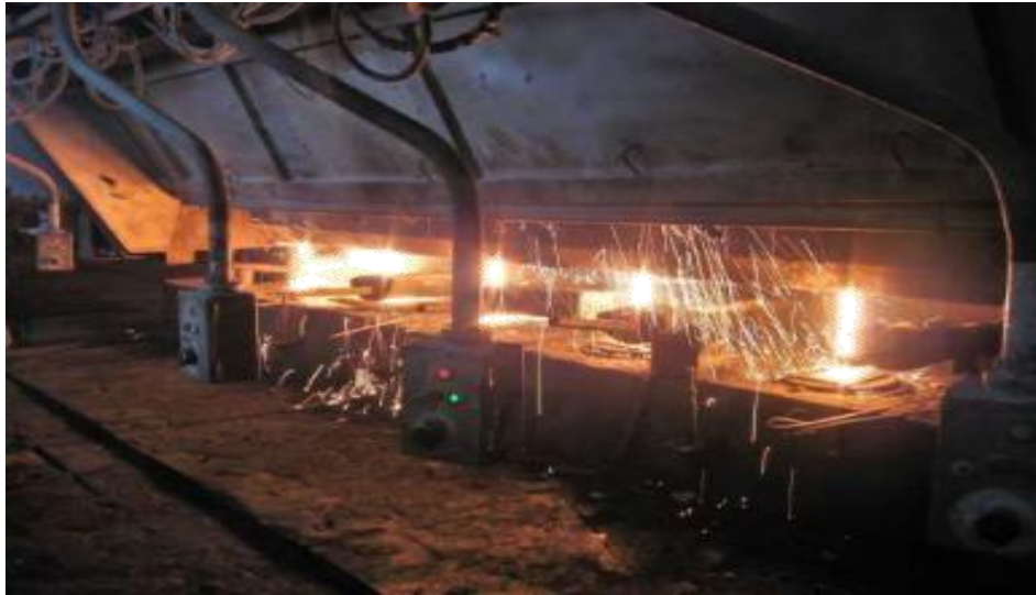
Şekil 4.9. Sürekli döküm ünitesindeki tandış ve sıvı çeliğin kalıplara dökülmesi
