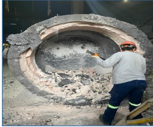
Şekil 2.6. Sıvı Çeliğin İçerisine Konulduğu Potaların Isıtılması Ve Tamirâtı
