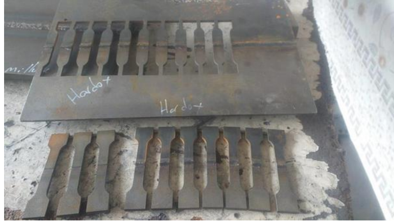
Şekil 5.3. MIG kaynak işlemi sonrası tel erozyon sonrası çekme numuneleri.
