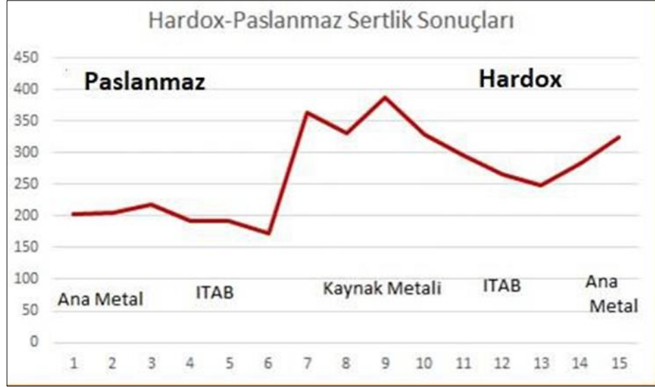
Şekil 6.3. Hardox-Paslanmaz sertlik sonuçları.
