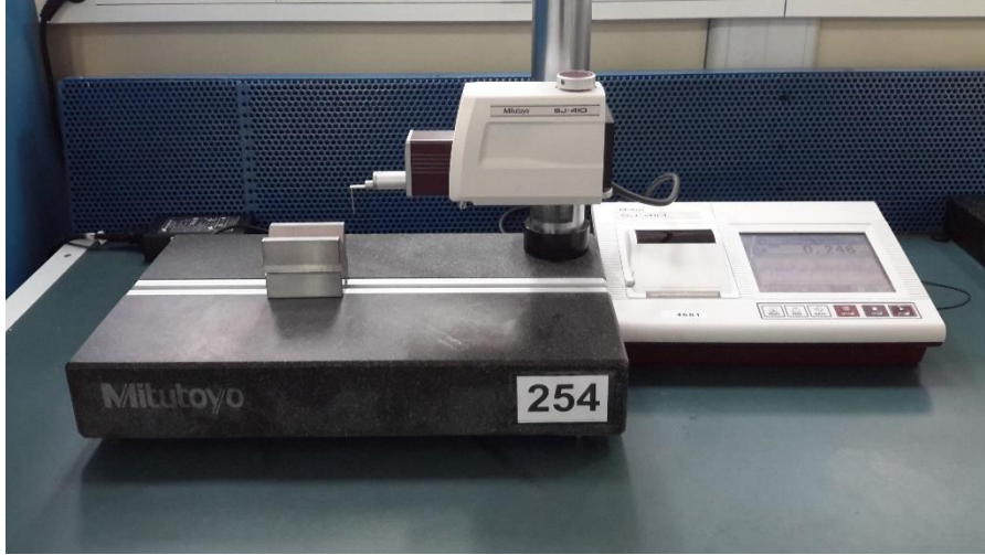
Şekil 7.10. Mituyoto marka SJ-410 model yüzey pürüzlük cihazı.
