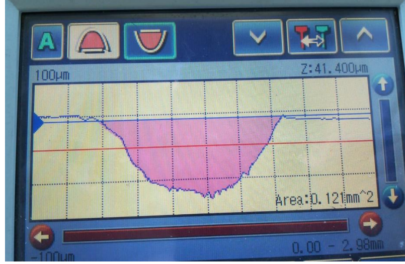
Şekil 8.8. Yüzeş profilometre cihazında kesit alan kaybı ölçümü.
