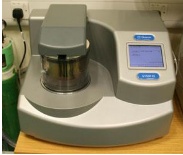
Şekil 7.4. Quorum markalı Q150R Rotary-Pumped Sputter Coater/Carbon Coater model yalıtkan kaplama cihazı.
