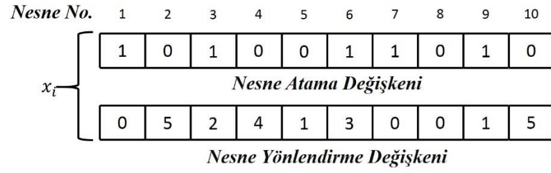
Şekil 4.1. TKYP’de nesne yerleştirme dizinlerinin yapısı
