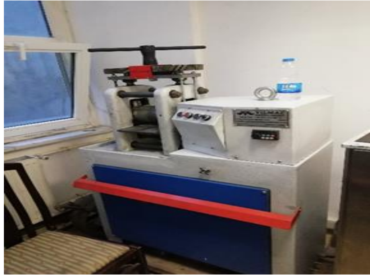
Şekil 3.6. Haddeleme işlemi için kullanılan soğuk hadde cihazı.
