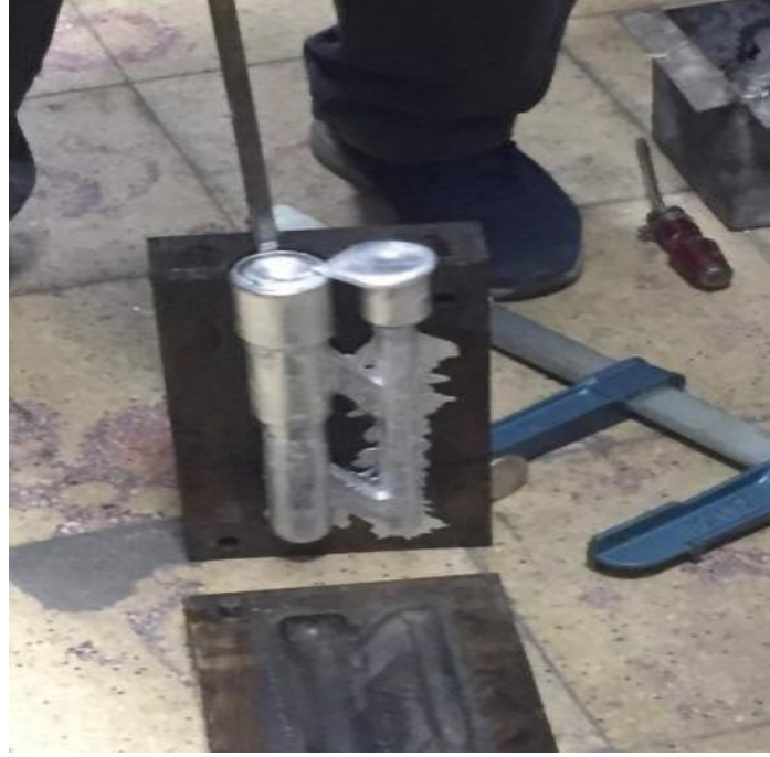
Şekil 3.3. %1,2 Bizmut ilaveli 5083 kalite alüminyum alaşımının metal kalıptan çıkarılması.
