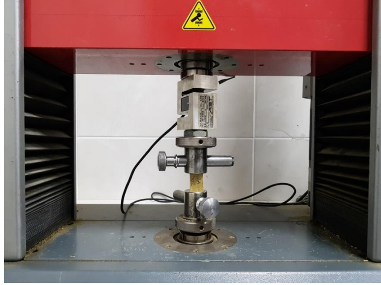
Şekil 5.6. Üniversal test cihazında liflere paralel basınç direnci deneyi.
