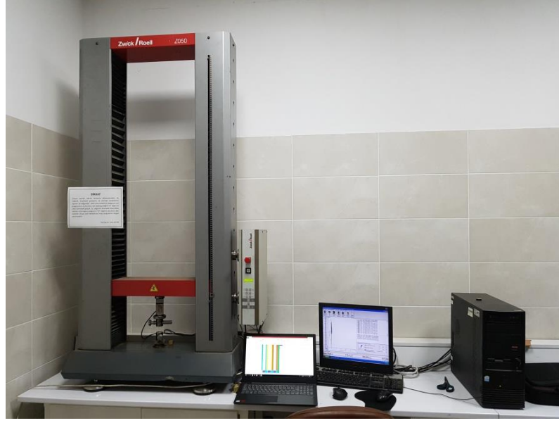
Şekil 5.5. Üniversal test cihazında liflere paralel basınç direnci deneyi.
