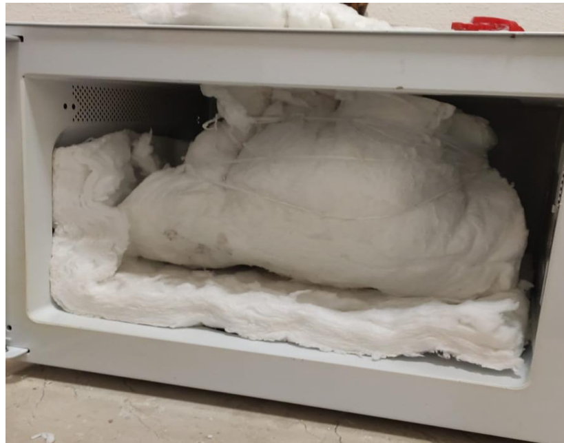
Şekil 4.7. Seramik yün ile kaplanmış reaktörün fırın içerisindeki görünümü.
