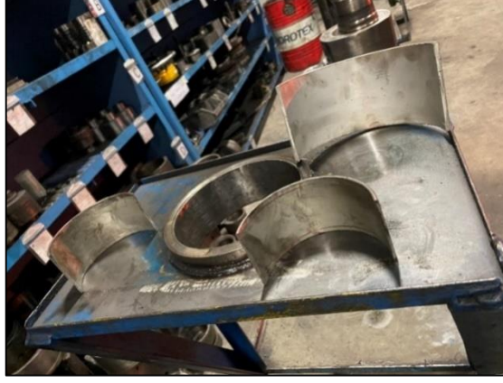
Şekil 2.21. Haddehane makinalarında kullanılan kaymalı yataklar.
