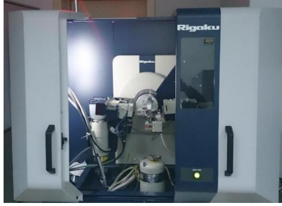
Şekil 5.10. Rigaku ultimate IV marka XRD cihazı.
