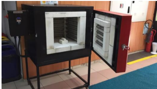
Şekil 5.2 İZOREF marka kamara indirekt ısıtmalı fırın.
