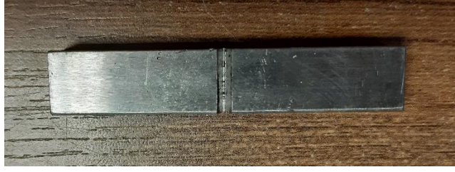
Şekil 5.15. (a) TS EN ISO 148-1 Standart şekli , (b) çentik numunesi.
