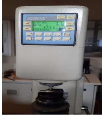
Şekil 5.14. Digirock sertlik ölçüm cihazı.
