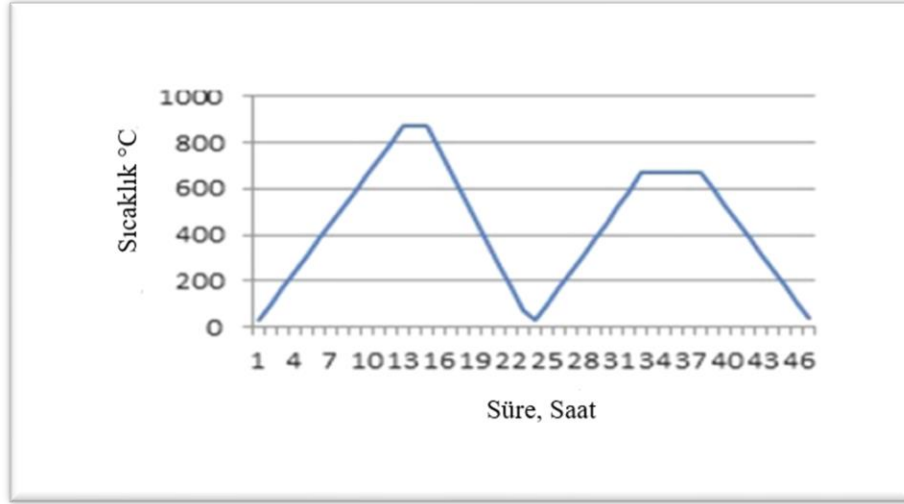
Şekil 5.4 Normalizasyon, havada soğutma, temperleme ve fırında kontrollü soğutma için sıcaklık-zaman grafiği.
