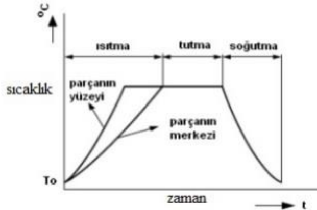
Şekil 4.1. Bir ısıl işlemde genel ısıl işlem süreci.
