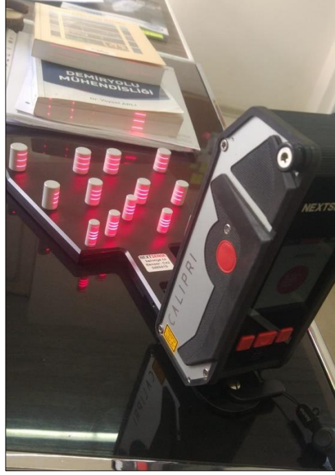
Şekil 5.3. Cihazın kalibre edilmesi.
