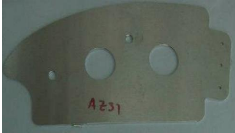
Şekil 2.2. Mg alaşımdan imal edilmiş uçak iskeleti sacı [12].
