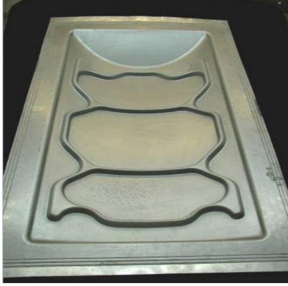
Şekil 2.3. Mg alaşımdan imal edilmiş Airbus A380 tipi uçağın servis kapısı [12].
