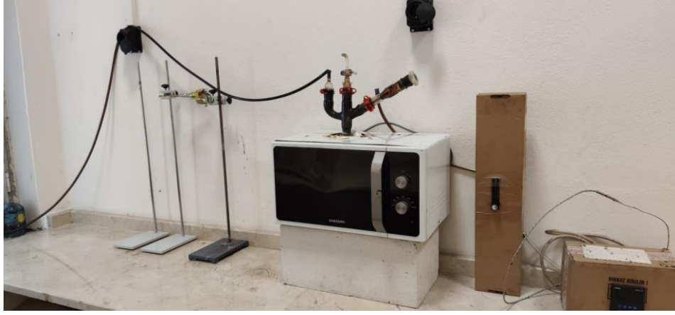
Şekil 5.4. Mikrodalga Destekli Piroliz Düzeneği.
