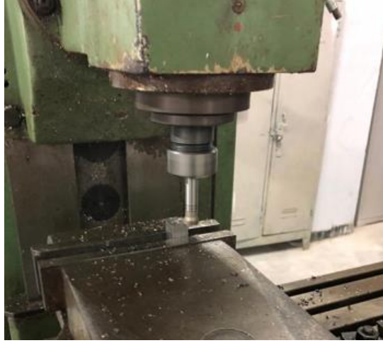
Şekil 4.11. Üniversal freze tezgahı.
