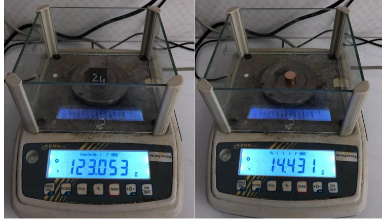
Şekil 4.9. İş parçası ve elektrot tartım işlemi.
