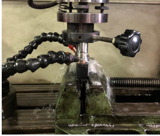
Şekil 4.5. Yanal püskürtme yöntemiyle iş parçasının dielektrik sıvı ile ıslatılması.
