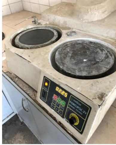
Şekil 4.10. Zımpara ve polisaj makinesi.
