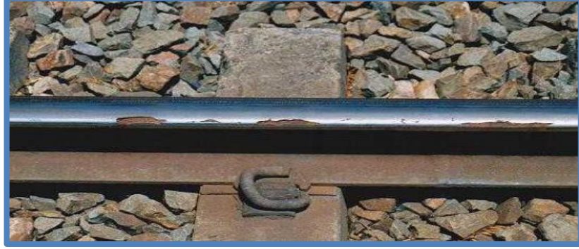
Şekil 2.7. Ray mantarında iç köşe kabuk atma (Shelling) [21].
