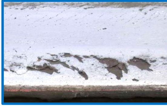
Şekil 2.27. Ray mantarında çentiklenmeler [10].
