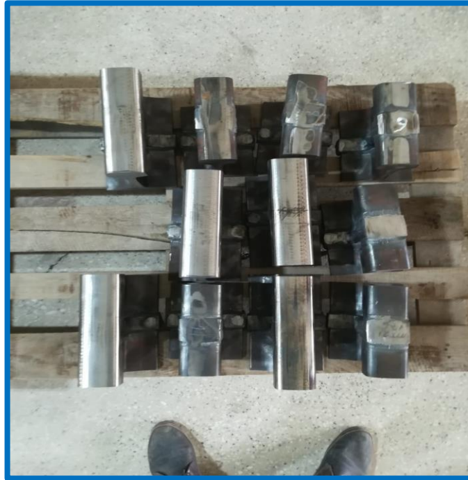
Şekil 4.13. Ultrasonik muayene için hazırlanan numuneler.
