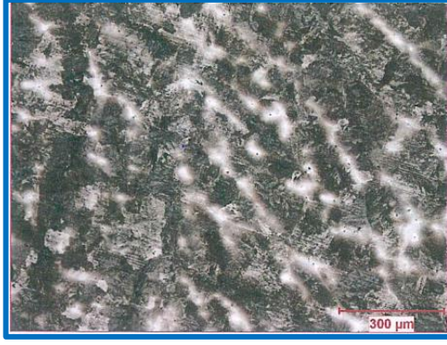
a-100X Ray Mantarı- Kaynaklı Bölge-Ana yapı Perlitik-Tane sınırlarında ferritler.
