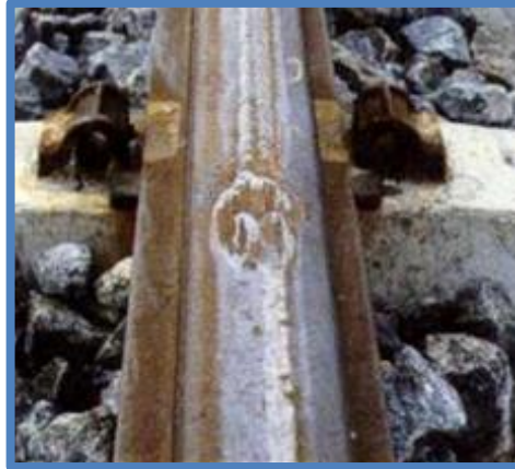
Şekil 2.10. Ray yüzeyinde oluşan tekil tekerlek yanığı kusuru [21].
