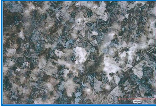
a-100X Ray mantarı-Kaynaklı Bölge- Perlitik İç yapı- Tane sınırlarında ferritler.
