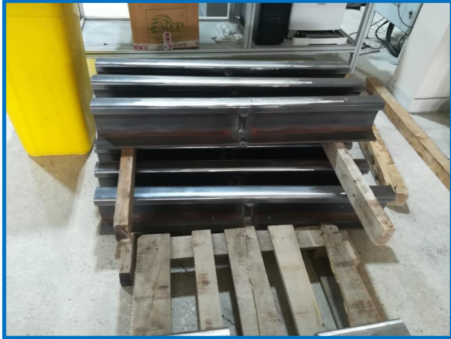
Şekil 4.7. Alüminotermite kaynağı yapılmış ve taşlanmış raylar.
