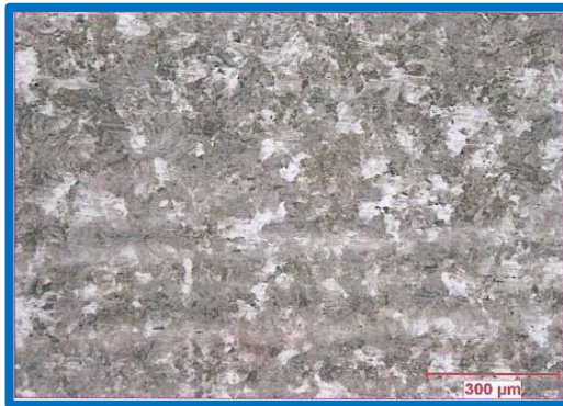
Şekil 4.1. R350HT Ray çeliğinin orijinal SEM mikroyapısı ve sertlik dağılımının şematik görünümü [54].
