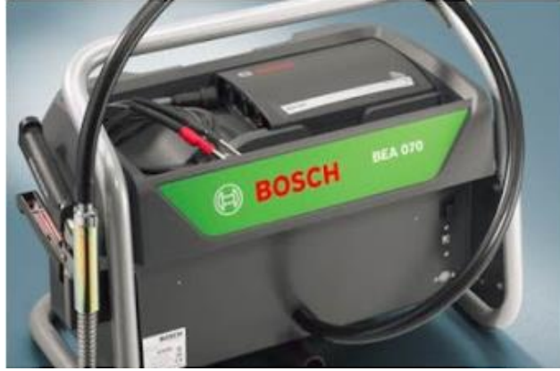
Şekil 6.3. Bosch BEA 070 is emisyonu ölçüm cihazı.
