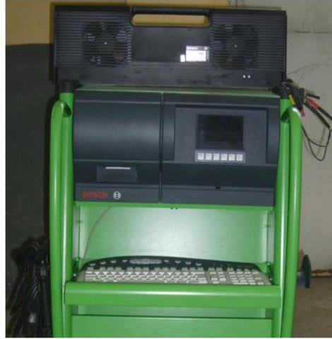
Şekil 6.2. Bosch BEA 350 egzoz emisyonu ölçüm cihazı.
