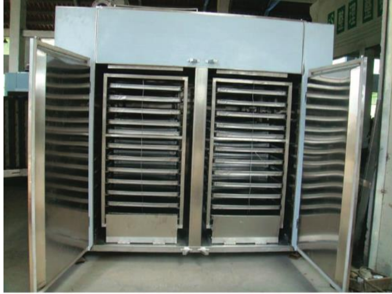
Şekil 3.1. Farklı laboratuvar türlerinde ve hatta çeşitli pilot ölçekli çalışmalarda yaygın olan çoklu tepsili vakumlu kurutucu [114].
