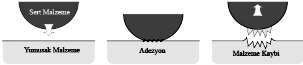
Şekil 4.4. Parçacık yapışması ve transfer işlemi [67].
