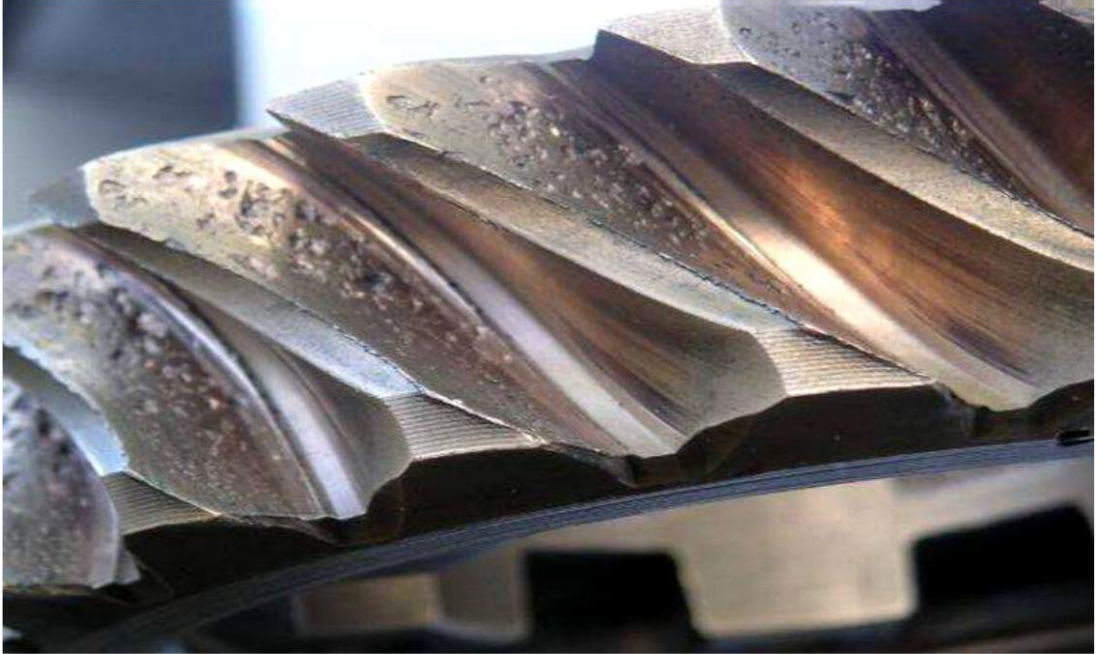
Şekil 4.6. Bir dişli çarkta meydana gelen yorulma aşınması örneği [67].
