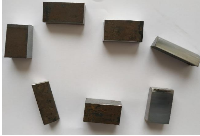
Şekil 6.2. Kesilmiş ray çeliği numuneleri.
