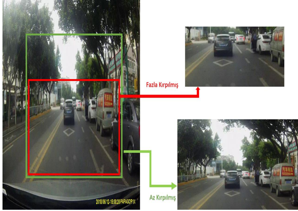
Şekil 3.9. Fazla kırılmış – az kırılmış kamera görüntüleri
