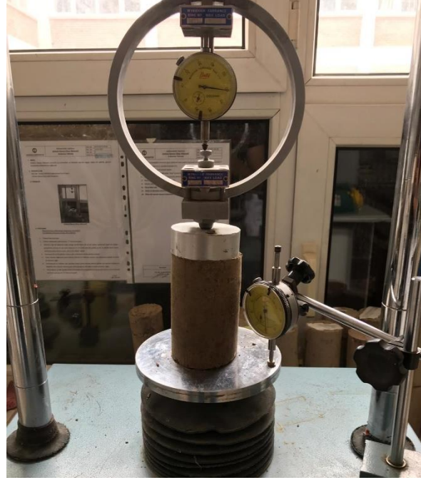
Şekil 3. Laboratuvarında hazırlanmış serbest basınç numunesi
