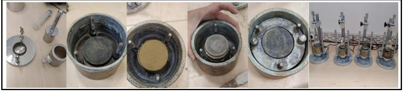
Şekil 3. Şişme basıncı deneyinin yapım aşamaları
