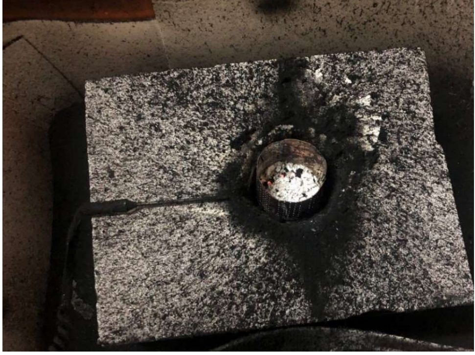
Şekil 6.14. Oksijen plazması ile yanma sonucu oluşan kül.
