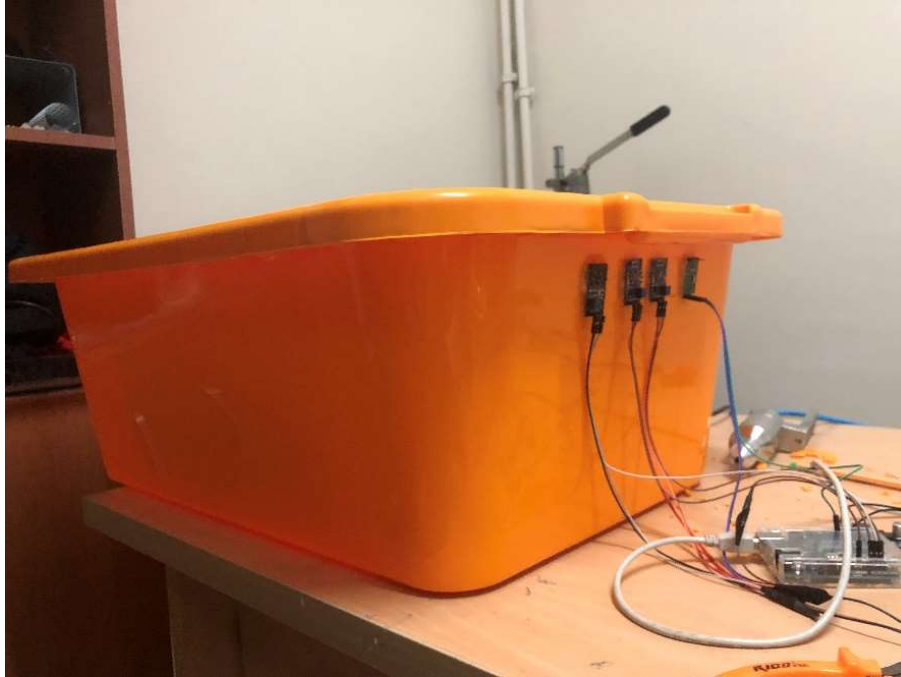
Şekil 5.3. Gaz sensörlerinin proses odasına monte edilmiş görüntüsü.
