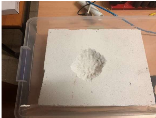
Şekil 5.12. Gaz betonunda yanma odasının oluşturulması.
