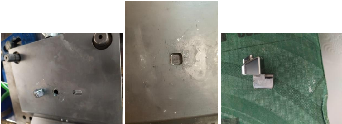
Şekil B.1. T çekirme bağlantı elemanında kullanılan maçanın kalıpta kırılmasına ait görünüş.
