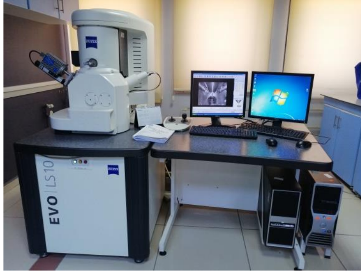
Şekil 4.13. Taramalı elektron mikroskobu (SEM) cihazı.
