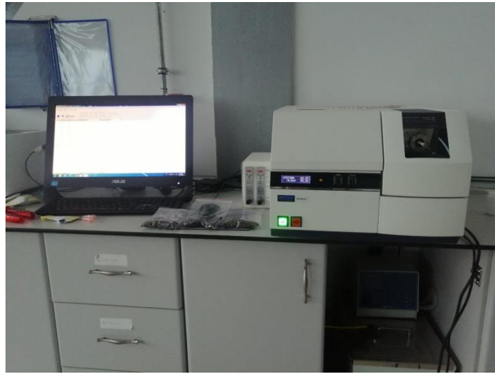
Şekil 4.12. TGA ve DSC analizlerinden bir görünüş.
