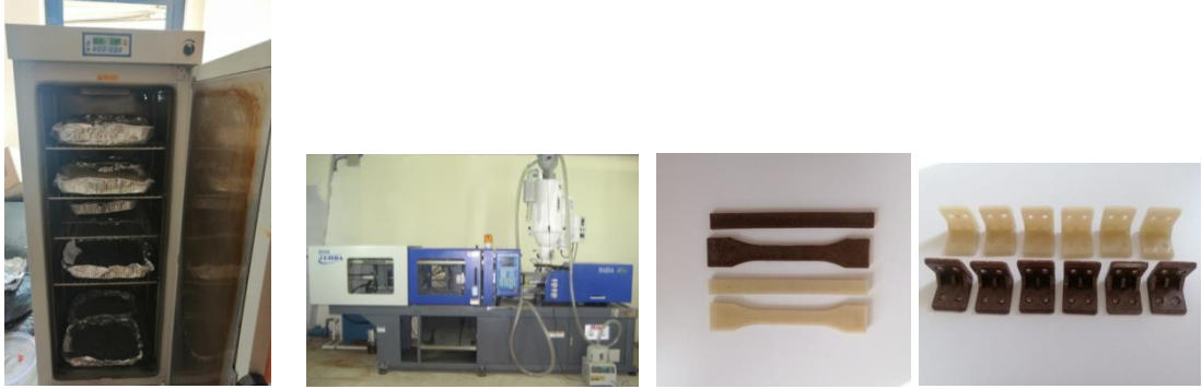
Şekil 4.8. Enjeksiyon kalıplama yöntemi ile üretim.
