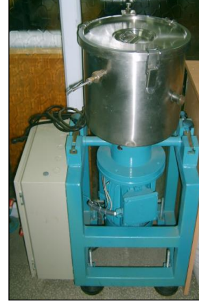
Şekil 4.5. Odun plastik kompozit üretiminde kullanılan karıştırıcı.
