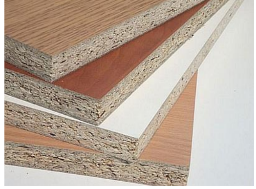
Şekil 2.3. Yonga levha ve melamin emprenyeli kâğıt ile kaplanmış yonga levha (YL-lam).
