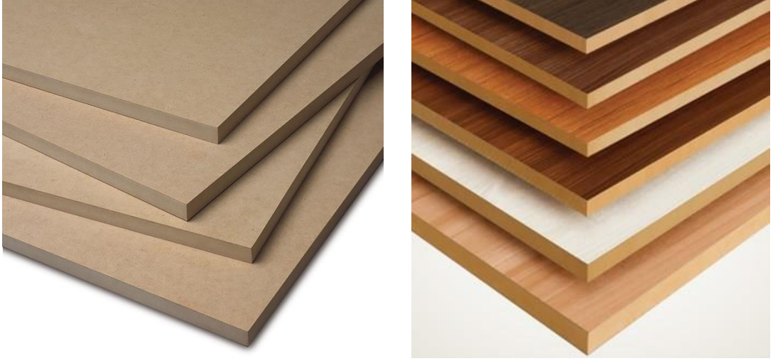
Şekil 2.2. Orta yoğunluklu lif levha (MDF) ve melamin emprenyeli kâğıt ile kaplanmış orta yoğunluklu lif levha (MDF-lam).
