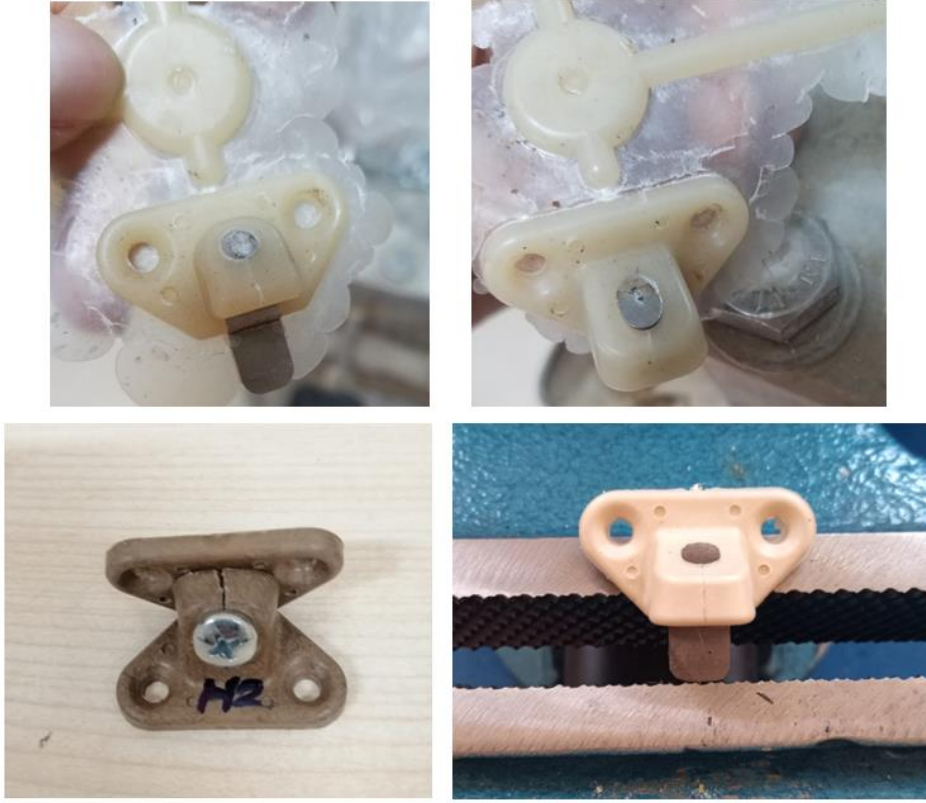
Şekil B.2. T çekirme bağlantı elemanının birleşim yerinde meydana gelen ayrılmalardan bir görünüş.
