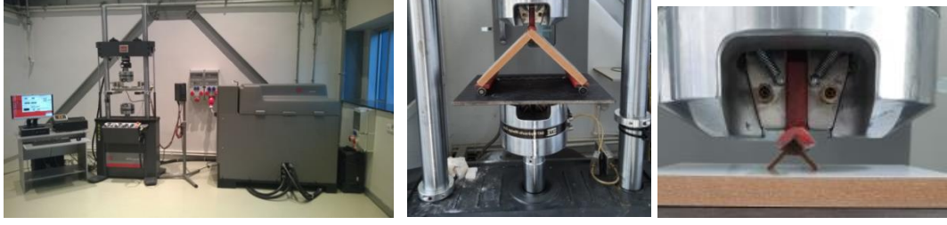
Şekil 4.17. MTS 100kN kapasiteli servo-hidrolik dinamik test cihazı ve yorulma testinden bir görünüş.
