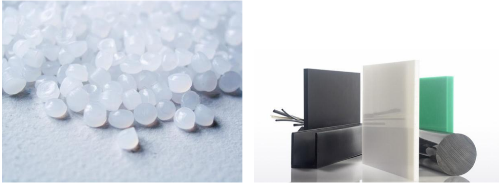
Şekil 3.4. HDPE' nin granül ve levha halindeki görünüşü.
