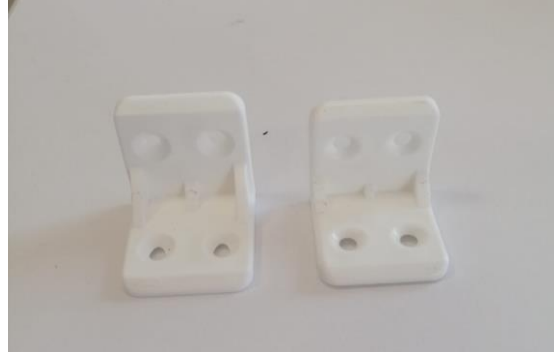
Şekil 4.2. Firma A ve Firma B' den temin edilen 'L' bağlantı elemanları.
