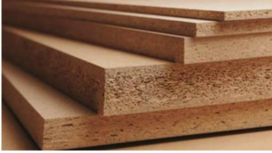
Şekil 2.3. Yonga levha ve melamin emprenyeli kâğıt ile kaplanmış yonga levha (YL-lam).
