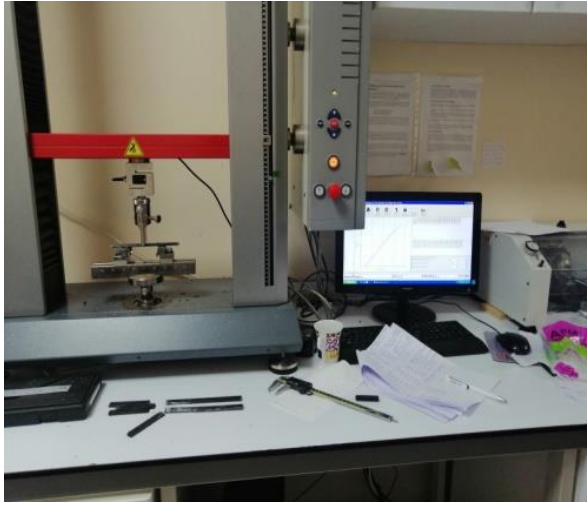
Şekil 4.10. OPK'lara uygulanan çekme ve eğilme testlerinden bir görünüş.
