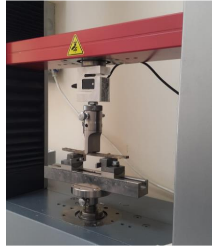
Şekil 4.10. OPK'lara uygulanan çekme ve eğilme testlerinden bir görünüş.
