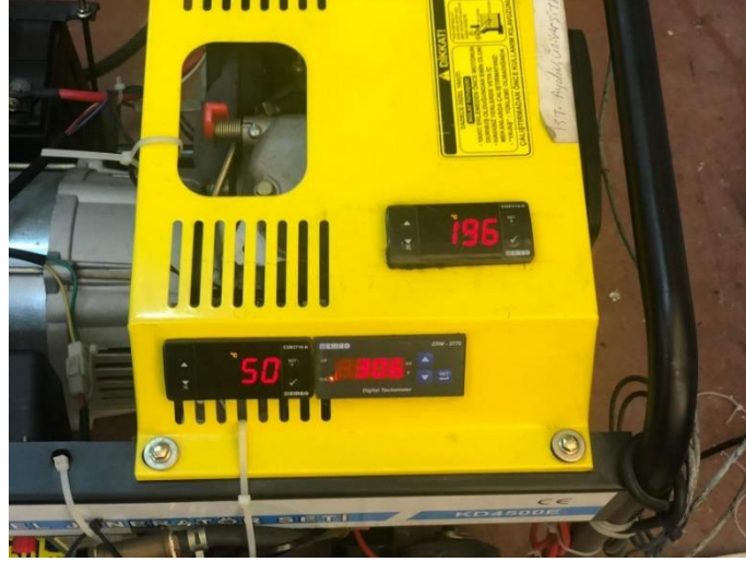
Şekil 5.3. Dizel jeneratörün yağ sıcaklık, egzoz sıcaklık ve devir sensörü
