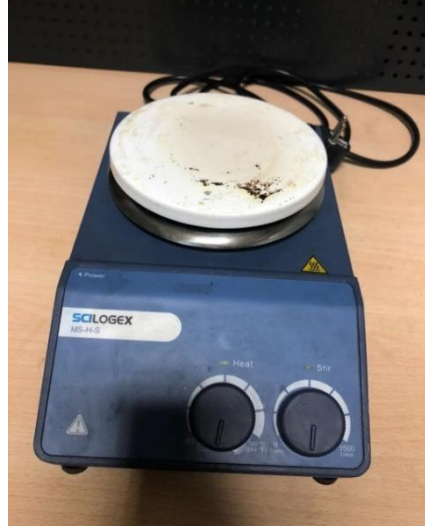
Şekil 5.6. SCİLOGEX MS-H-S manyetik karıştırıcı
