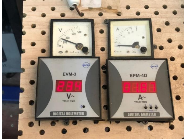
Őekil 5.9. Dijital voltmetre ve dijital ampermetre
