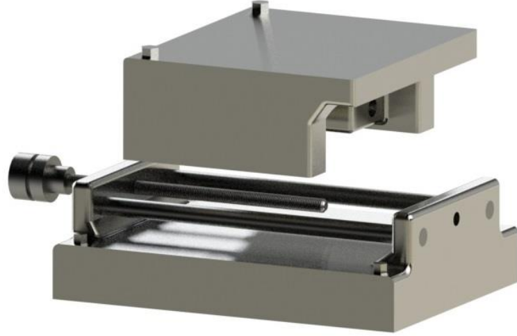
Şekil 4.3. Kurs boyu ayarlanabilen lineer kaymalı yatak.
