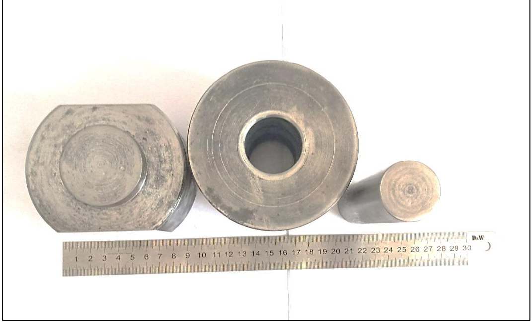
Şekil 5.3. Tozların preslenmesinde kullanılan kalıp ve zimba.
