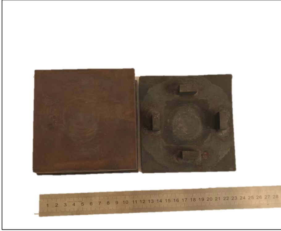
Şekil 5.5. Numunelerin %30 ve %60 oranında deforme edilmesinde kullanılan alt ve üst plaka (c).
