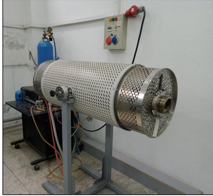
Şekil 5.4. Sinterleme işleminde kullanılan atmosfer kontrollü fırın.
