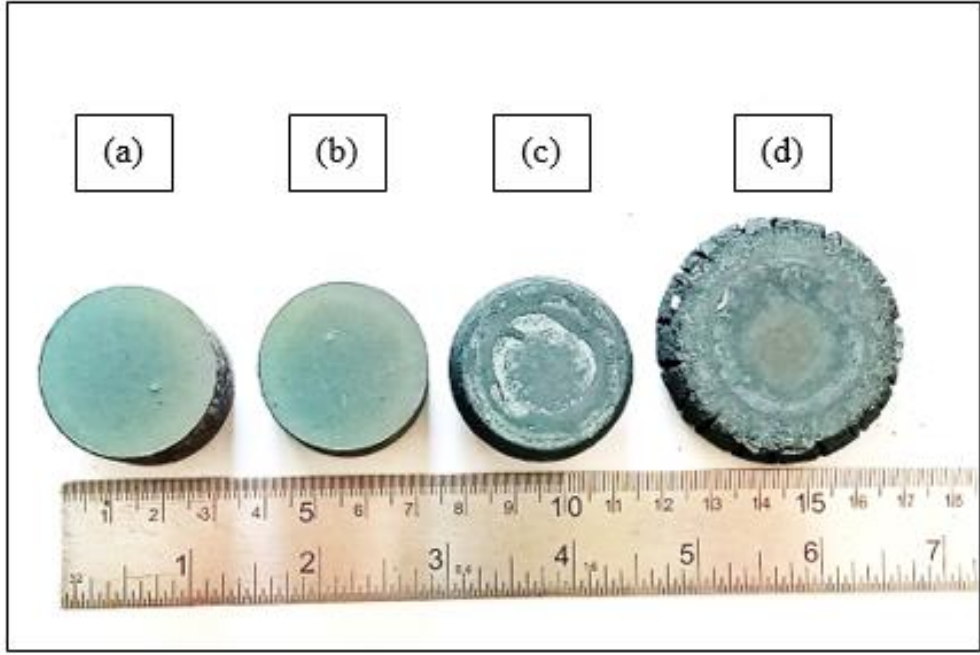
Şekil 10.6. Deneysel çalışma için hazırlanan numunlerin genel görüntüsü, a) sinterlenen, b) homojenleştirilen, c) %30 deforme edilen, d) %60 deforme edilen.
