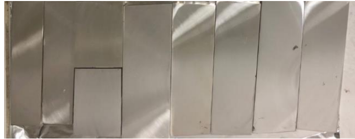
Şekil 4.5. Hadde öncesi yüzey işleme tamamlanmış plakalar.
