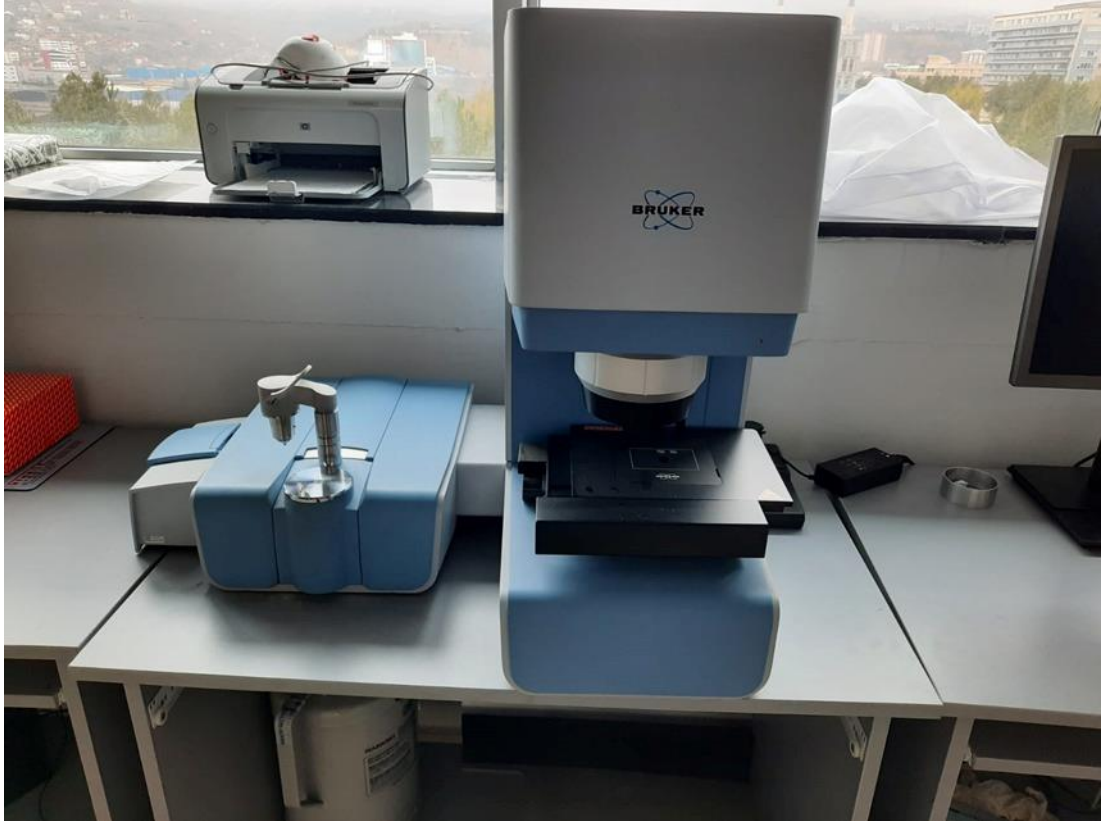
Ŗekil 3.5. Fourier DönüŖümlü Kızılaltı Spektroskopisi (Karabük Üniversitesi Demir Çelik Enstitüsü).
