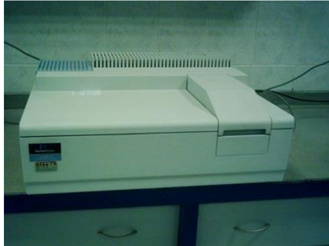
Şekil 3.4. Perkin Elmer Lambda 25 UV-VIS spektrometresi.
