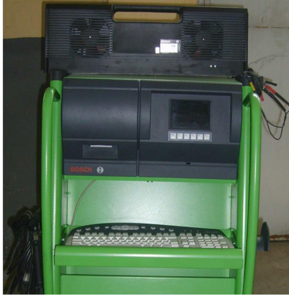
Şekil 4.2. Bosch-BEA 350 emisyon ölçüm cihazı.
