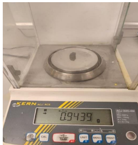
Şekil 6.3. Su emme ve gözeneklilik testinde ağırlık hesaplamak için kullanılan hassas terazi.
