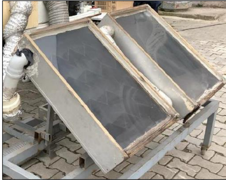
Şekil 6.3. Deneyde kullanılan havalı güneş kolektörü gösterimi.
