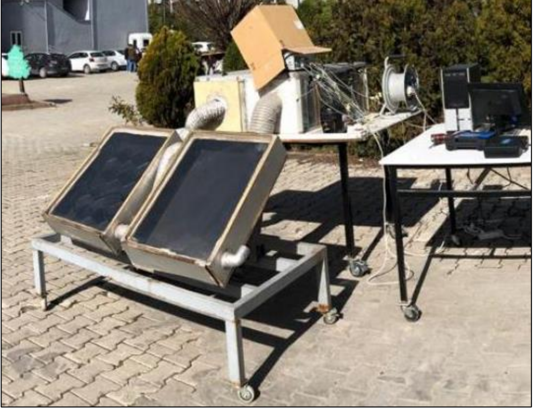
Şekil 7.2. Deney seti ve havalı güneş kolektörünün genel gösterimi.
