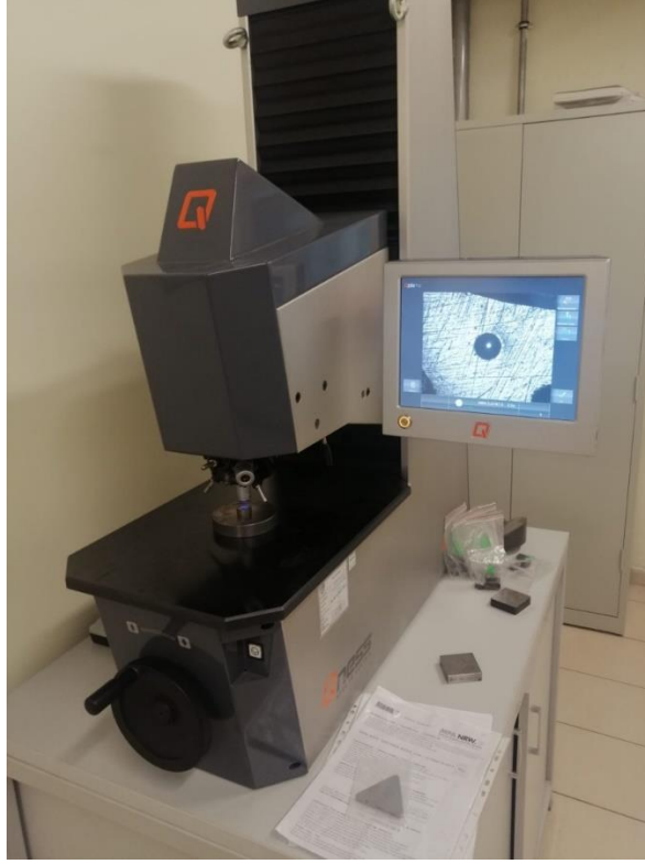
Şekil 5.6. Qness Q250M makro sertlik ölçüm cihazı Brinell (HBW).
