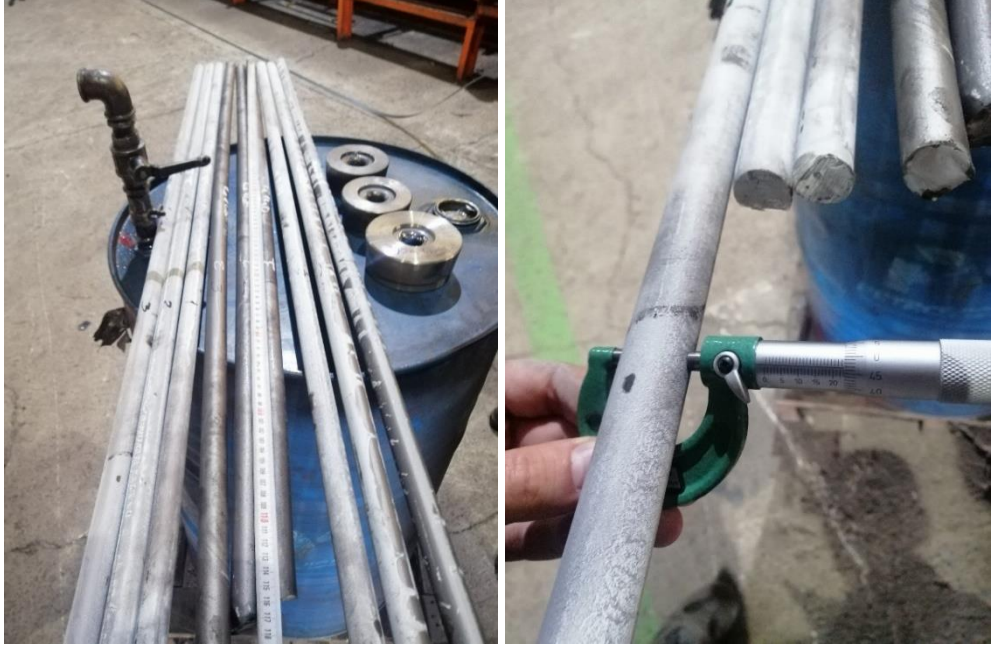
Şekil 5.3. Soğuk çekmeye hazır çubuklar ve soğuk çekme kalıpları.
