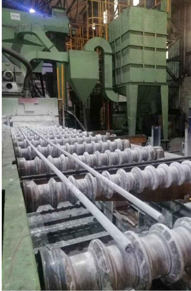
Şekil 5.2. Kumlama makinesi ve kumlama sonrası kireç kaplanmış çubuklar.
