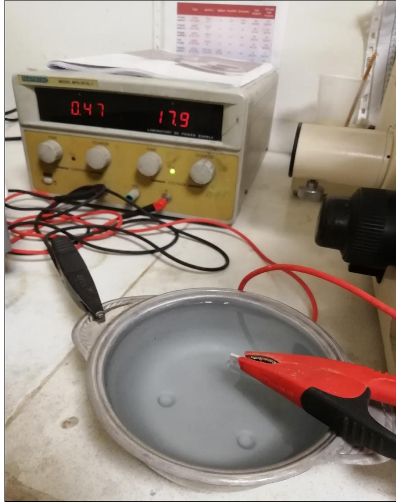
Şekil 5. 13. Elektrolitik dađlama dűzeneđi.
