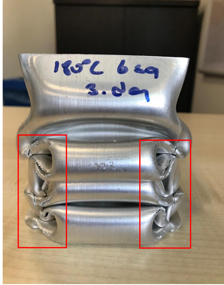
Şekil 6. 46. 180°C’de 6 saat yaşlandırılmış kare profil basma testi uygulanmış numunesi.
