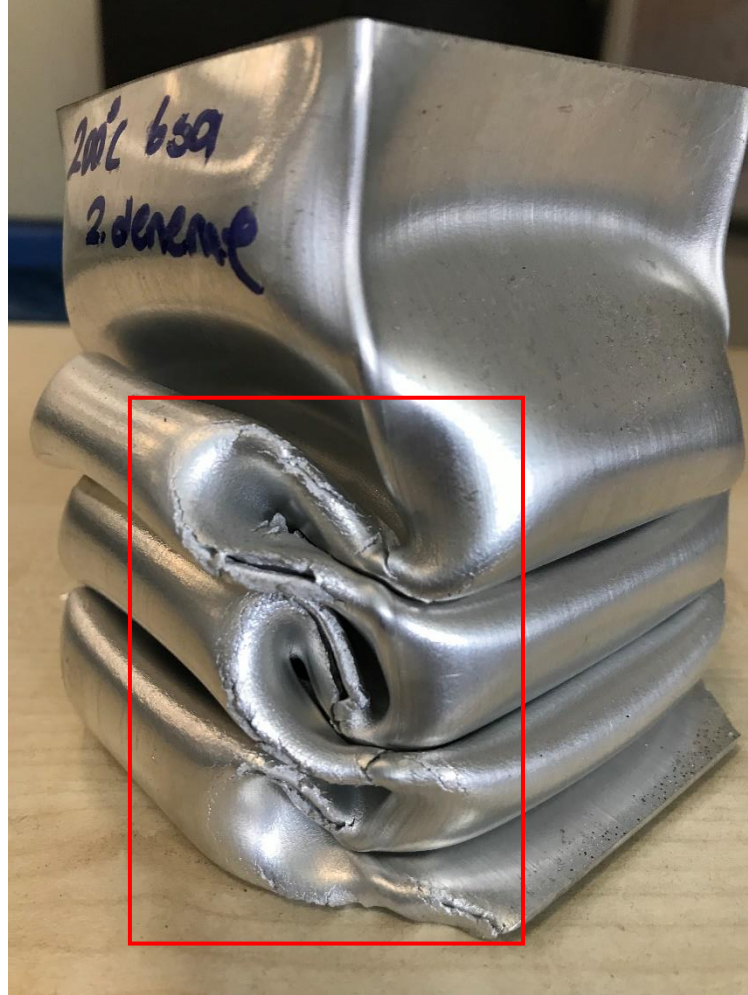
Şekil 6. 51. 200°C’de 6 saat yaşlandırılmış kare profil basma testi uygulanmış numunesi.
