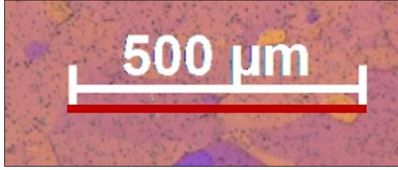
Şekil 5. 18. Mikroyapı görüntüsündeki ölçek kadar çizgi çizilmesi.
