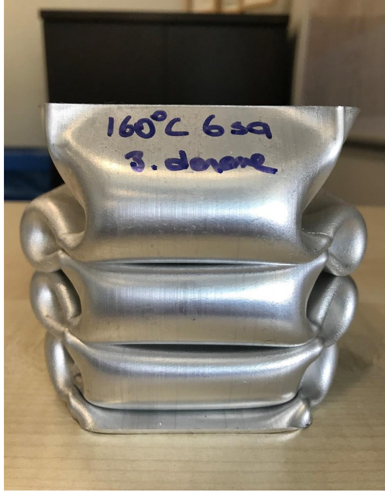
Şekil 6. 41. 160°C'de 6 saat yaşlandırılmış kare profil basma testi uygulanmış numunesi.
