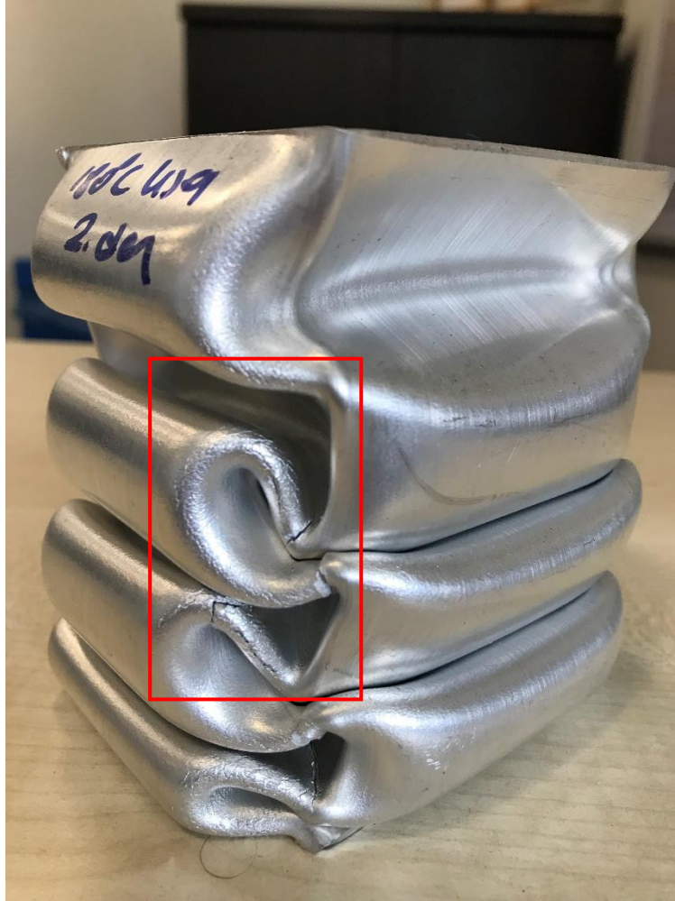
Şekil 6. 45. 180°C’de 4 saat yaşlandırılmış kare profil basma testi uygulanmış numunesi.
