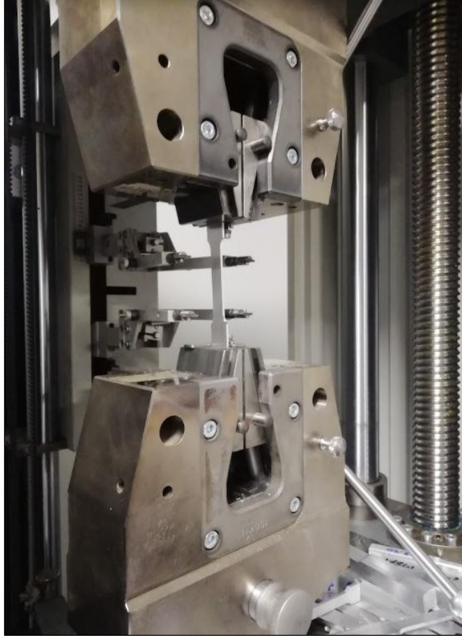
Şekil 5. 14. Çekme testi uygulaması.
