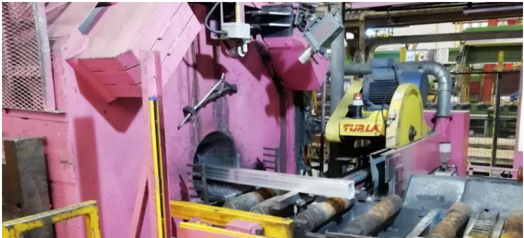
Şekil 5. 3. Kare profilin ekstrüzyonu sırasında presten çıkışı.
