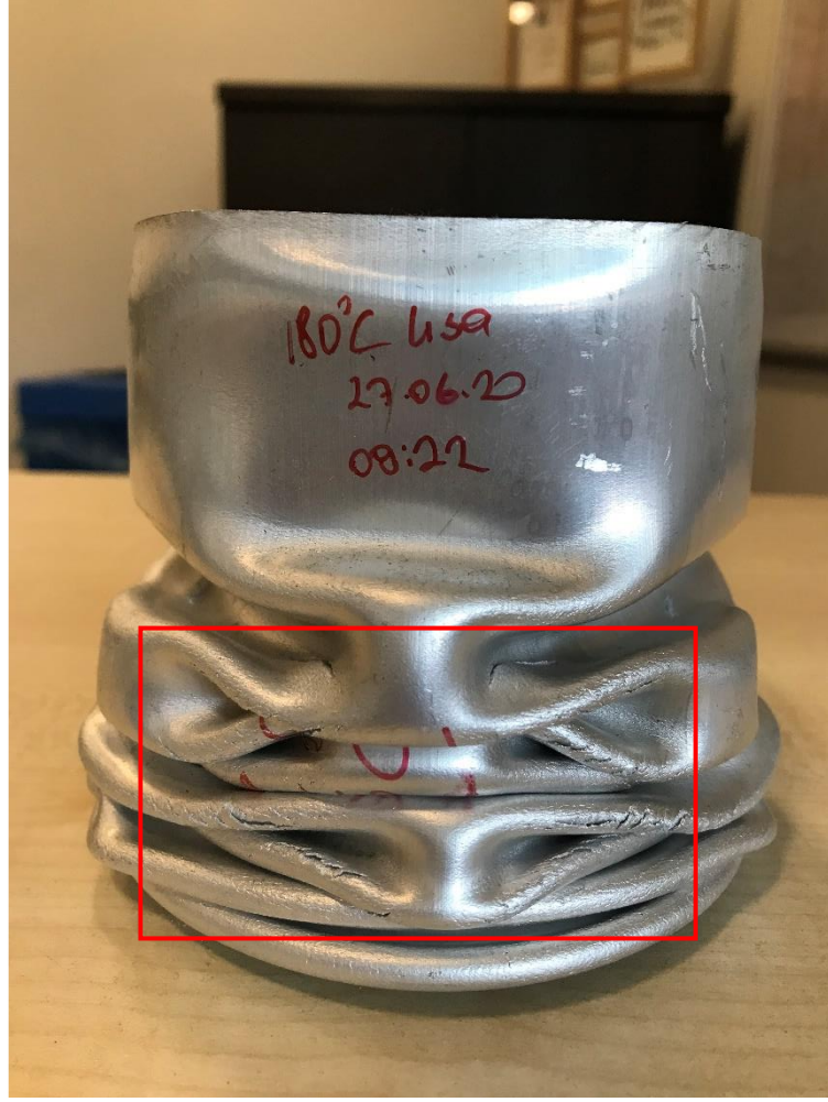
Şekil 6. 60. 180°C’de 4 saat yaşlandırılmış dairesel profil basma testi uygulanmış numunesi.
