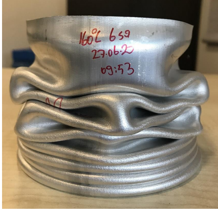
Şekil 6. 56. 160°C’de 6 saat yaşlandırılmış dairesel profil basma testi uygulanmış numunesi.
