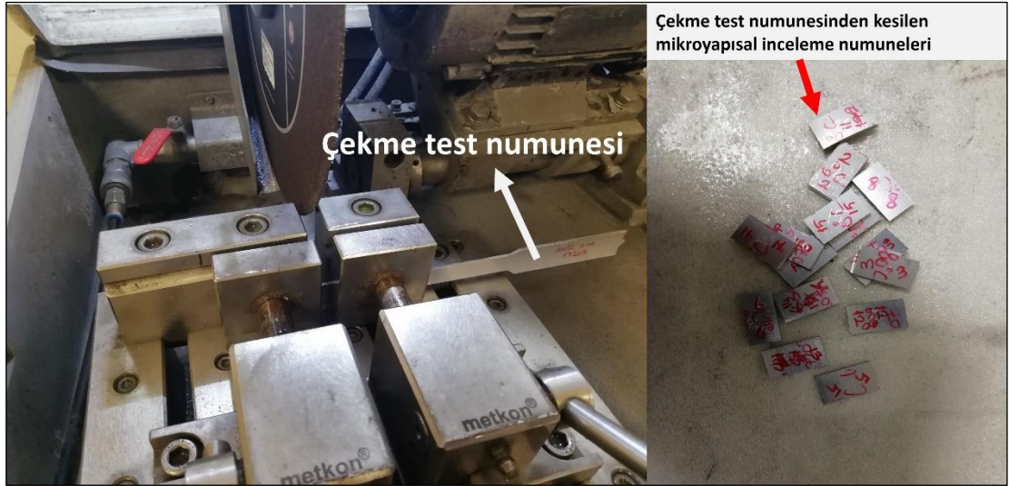
Şekil 5. 9. Mikroyapısal inceleme numunesi kesimi.
