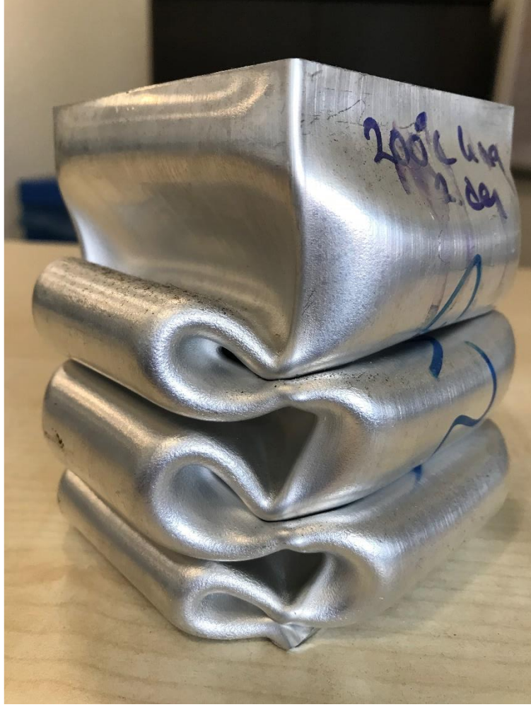
Şekil 6. 48. 200°C’de 4 saat yaşlandırılmış kare profil basma testi uygulanmış numunesi.
