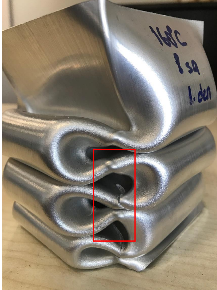
Şekil 6. 44. 160°C'de 8 saat yaşlandırılmış kare profil basma testi uygulanmış numunesi.
