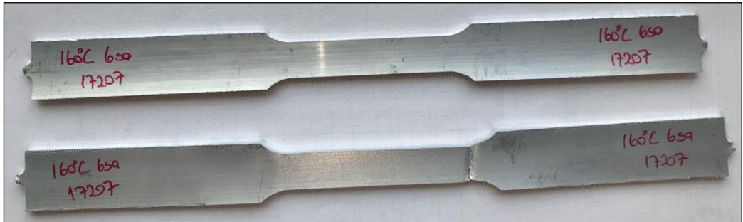
Şekil 5. 15. Çekme testi uygulanmadan önce ve sonra numune.
