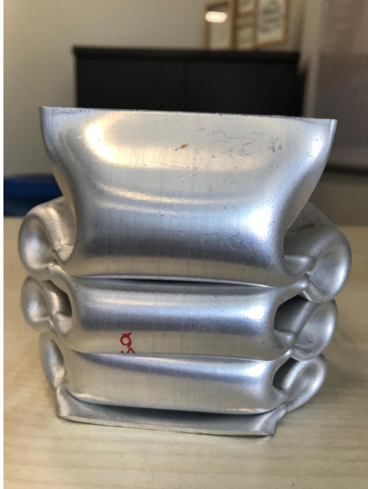
Şekil 6. 38. 160°C'de 4 saat yaşlandırılmış kare profil basma testi uygulanmış numunesi.
