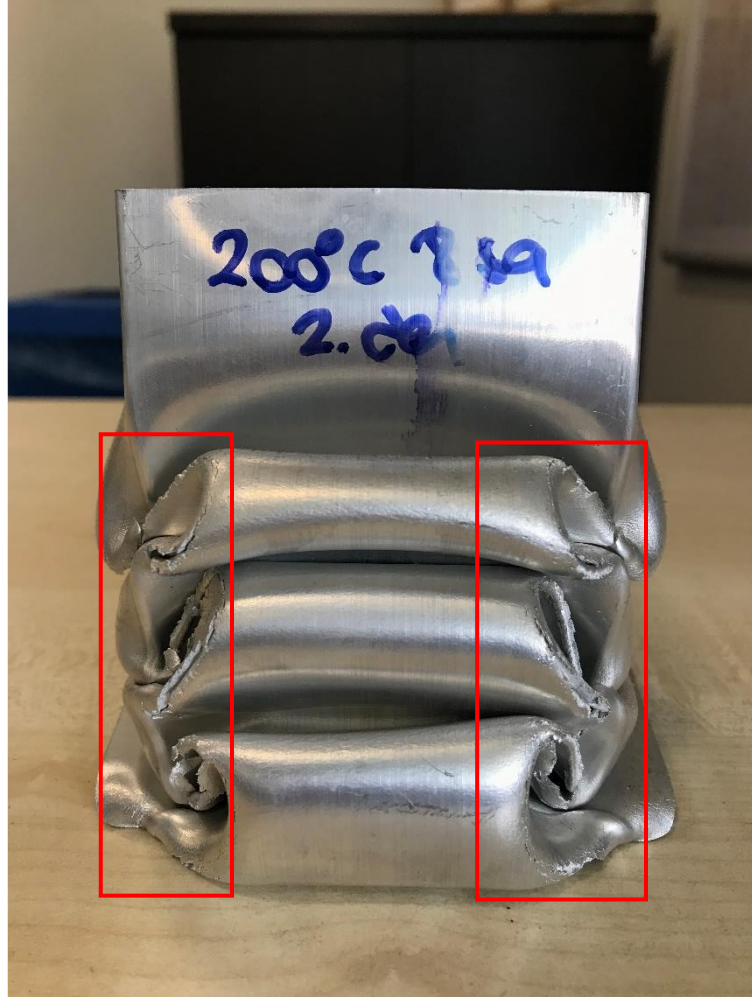
Şekil 6. 52. 200°C’de 8 saat yaşlandırılmış kare profil basma testi uygulanmış numunesi.
