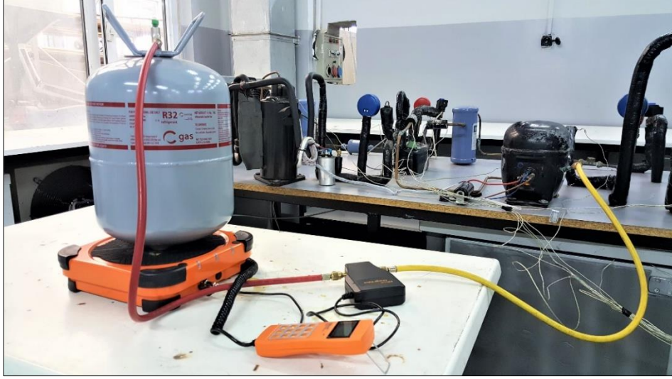
Şekil 5.14. R32 soğutucu akışkan şarjı uygulaması.
