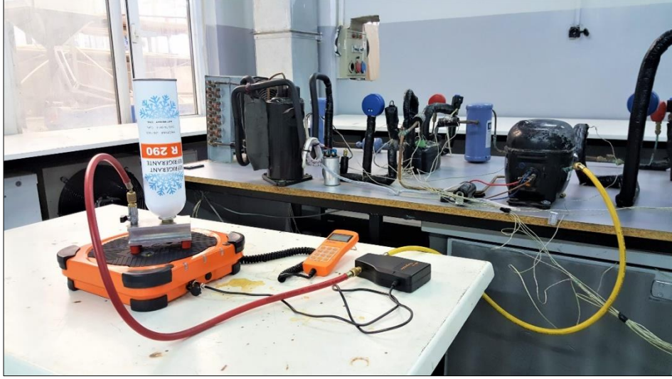
Şekil 5.13. R290 soğutucu akışkan şarjı uygulaması.
