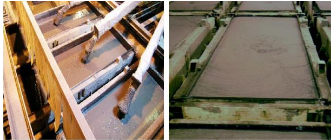
Şekil 3.2. Gaz beton üretiminde sulu harcın kalıba dökülmesi ve kabarma süreci [26].
