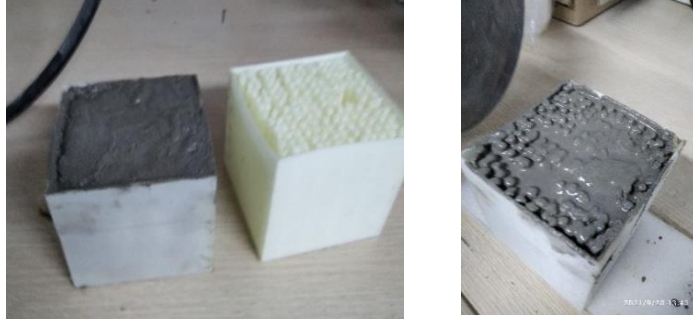
Şekil 6.8. Numunelerin 3B boşluklu kalıplara yerleştirilmesi.
