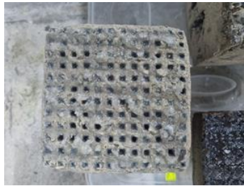
Şekil 6.10. PVA plastik kalıbın suda çözünme aşaması.
