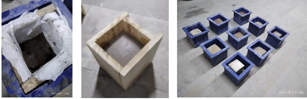
Şekil 6.4. Gaz beton karışımının küp kalıplara doldurulması.
