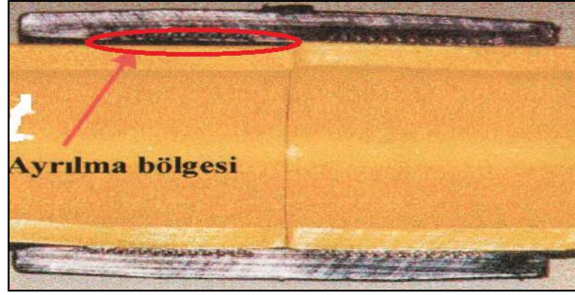
Şekil 5.6. Oval boru kullanılması sonucu kesim sırasında ayrılan kaynak bölgesi [6].
