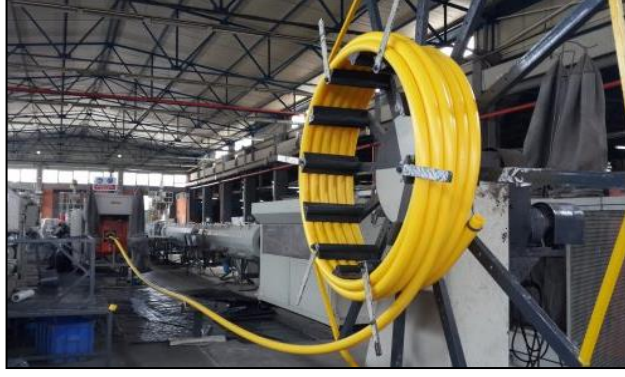
Şekil 2.6. Polietilen boru imalatı ve boruların kangal olarak üretilmesi [11].
