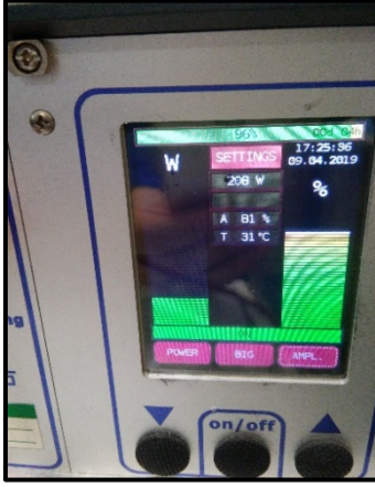
Şekil 3.8. Genliğin % 80'de, sıcaklığın 31 C°de sabit tutulması.
