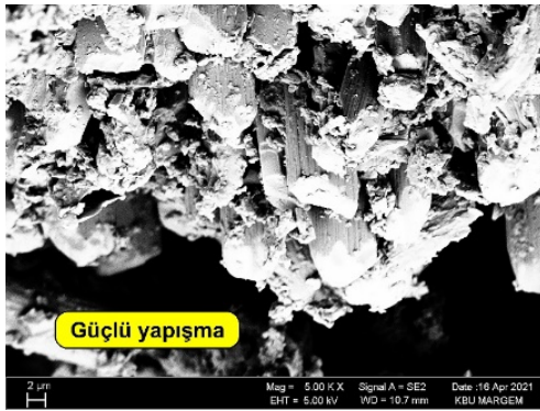
Şekil 4.15. Maksimum gerilim genliğinde yorulma testi numunelerinin SEM mikro yapı görüntüleri a-e) % 1,5 MWCNT b-c) % 0,5 MWCNT d) % 1 MWCNT f) % 1 MWCNT g) 0,5 MWCNT h) % 1,5 MWCNT
