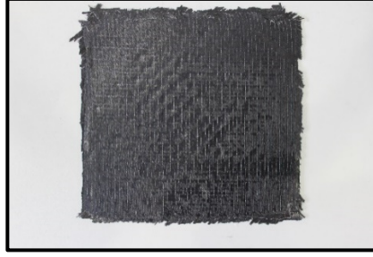
Şekil 3.21. Çekme ve yorulma numuneleri için kompozit plakanın üretilmesi.
