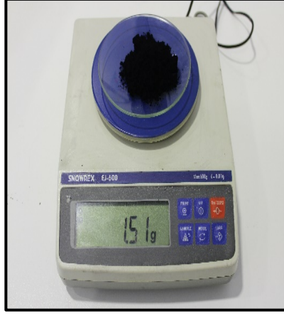
Şekil 3.4. MWCNT miktarının hesaplanarak tartılması.
