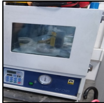
Şekil 3.12. Çözeltinin vakum fırınında gazdan arındırılması.
