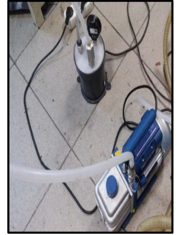
Şekil 3.19. Reçine hattının kapatılarak vakumlama işleminin yapılması.
