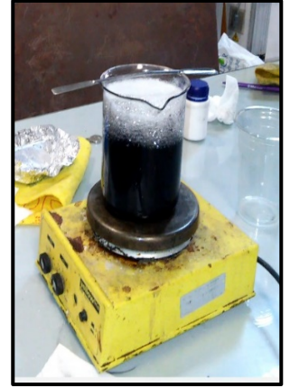
Şekil 3.10. 80 C°de solventin (Etanol) buharlaştırma.
