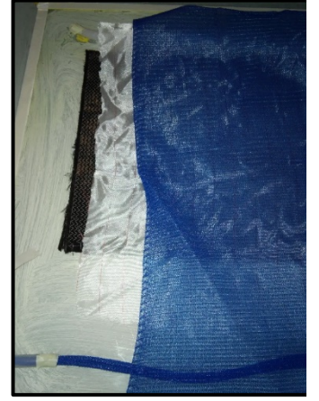
Şekil 3.16. Sıyırma kumaşı ve reçine akış filesinin serilmesi.
