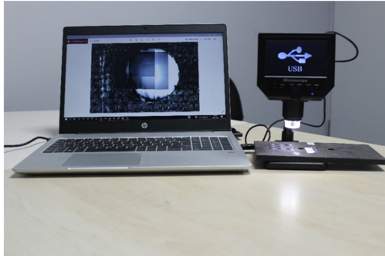
Şekil 3.39. Delik görüntüsünün dijital mikroskop ile alınması.
