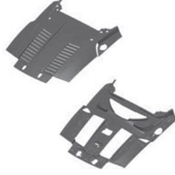
Şekil 1.10. İki parçadan oluşan CFRP bagaj kapağı [37,38].
