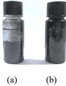
Şekil 4.1. MWCNT dispersiyonu, a) Süre 1 saat b) Süre 10 saat.
