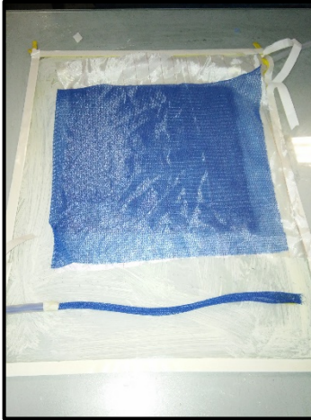
Şekil 3.17. Reçine ve vakum hattının yerleştirilmesi.
