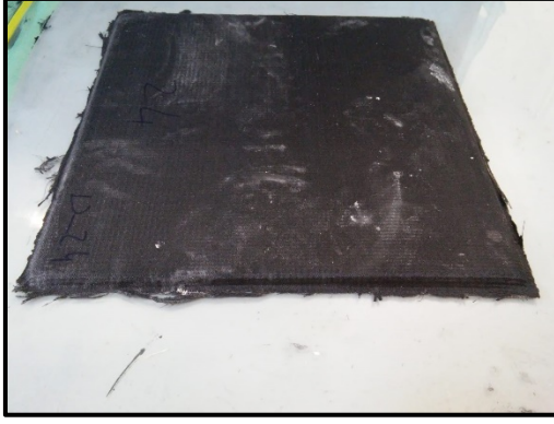
Şekil 3.27. Delme işlemi için 10 mm kalınlığındaki NCF CFRP Kompozitin elde edilmesi.
