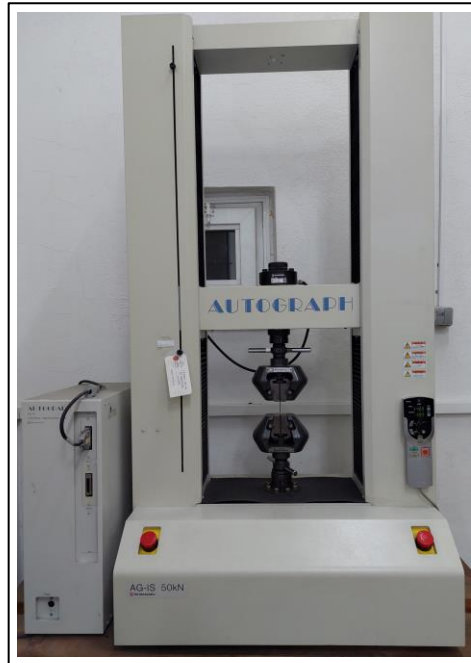
Şekil 4.16. Çekme test makinesi.
