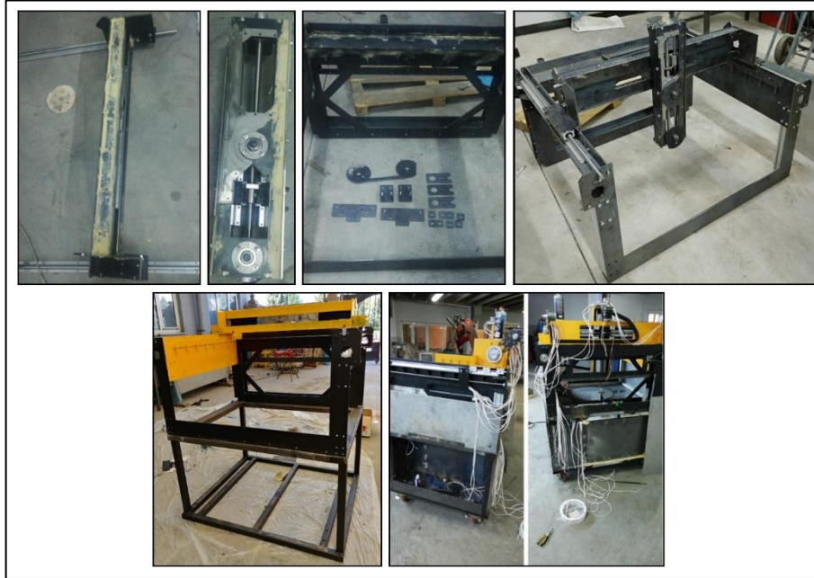
Şekil 4.2. TAEİ tezgahı imalat aşamalarından resimler.
