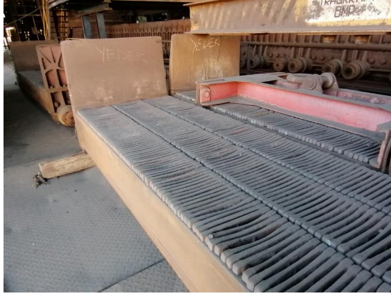
Şekil 2.5. Sinter paleti üzerine dizilmiş ızgaralar.
