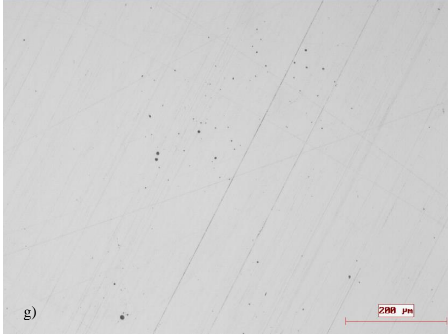
Şekil 6.10. 1 numaralı numuneye ait inklüzyonlar (a, b,c, d, e, f, g).
