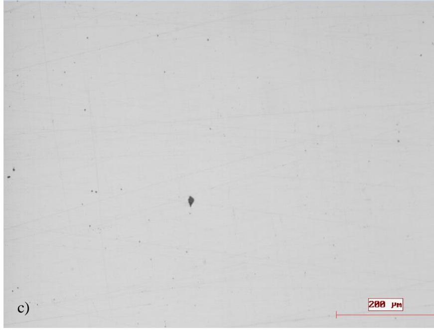
Şekil 6.12. 3 numaralı numuneye ait inklüzyonlar (a, b, c).
