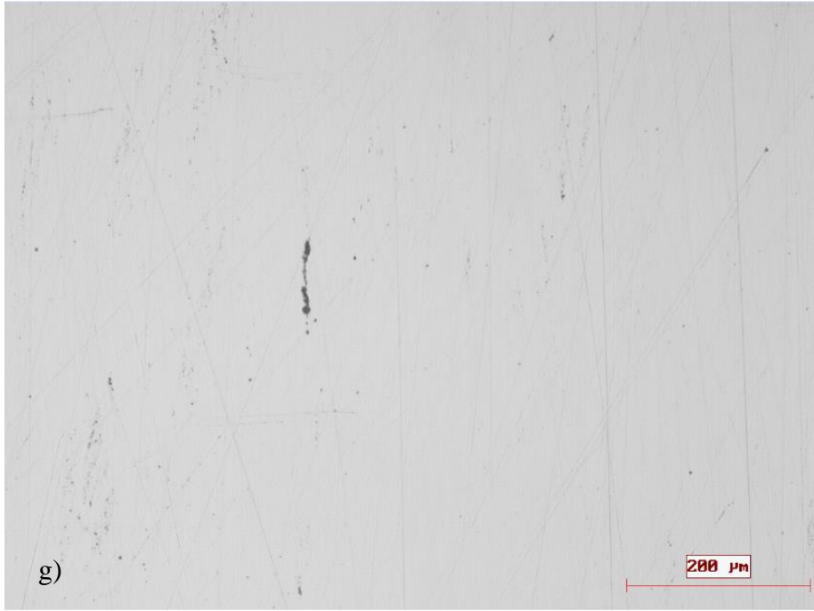
Şekil 6.11. 2 numaralı numuneye ait inklüzyonlar (a, b, c, d, e, f, g).
