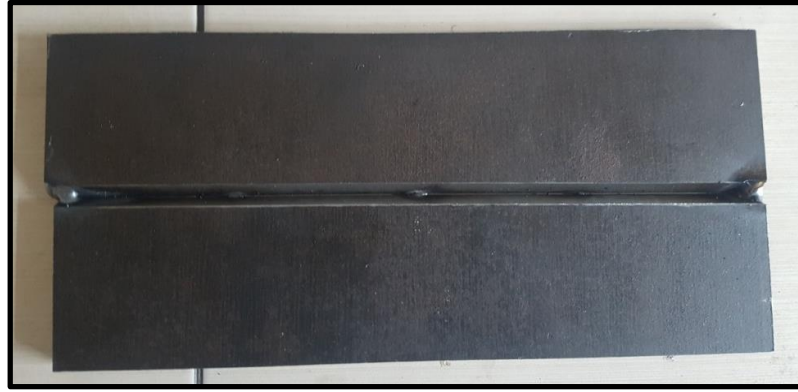
Şekil 4.2. Levhaların puntalanmış görüntüsü.
