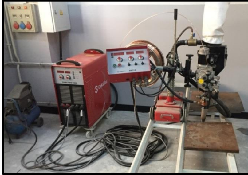
Şekil 4.5. Deneysel çalışmalarda kullanılan tozaltı ark kaynak makinesi.
