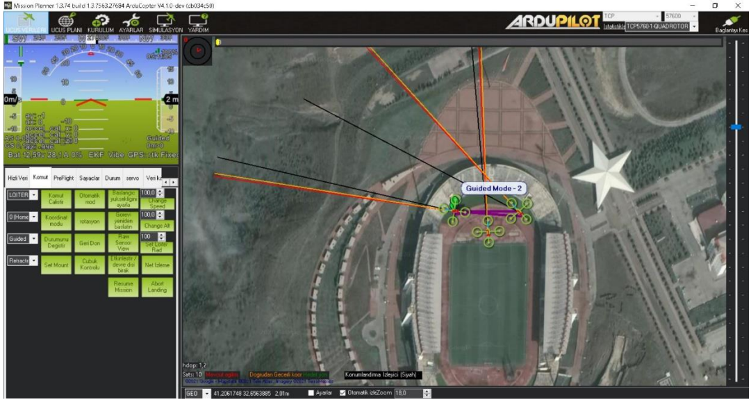
Şekil 3.8. SITL simülasyonu eş zamanlı sürü görev testi.
