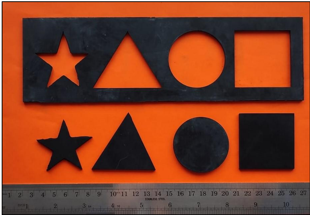
Őekil 5.2. Kauçuk malzeme geometrik Őekil kesim örneęi.
