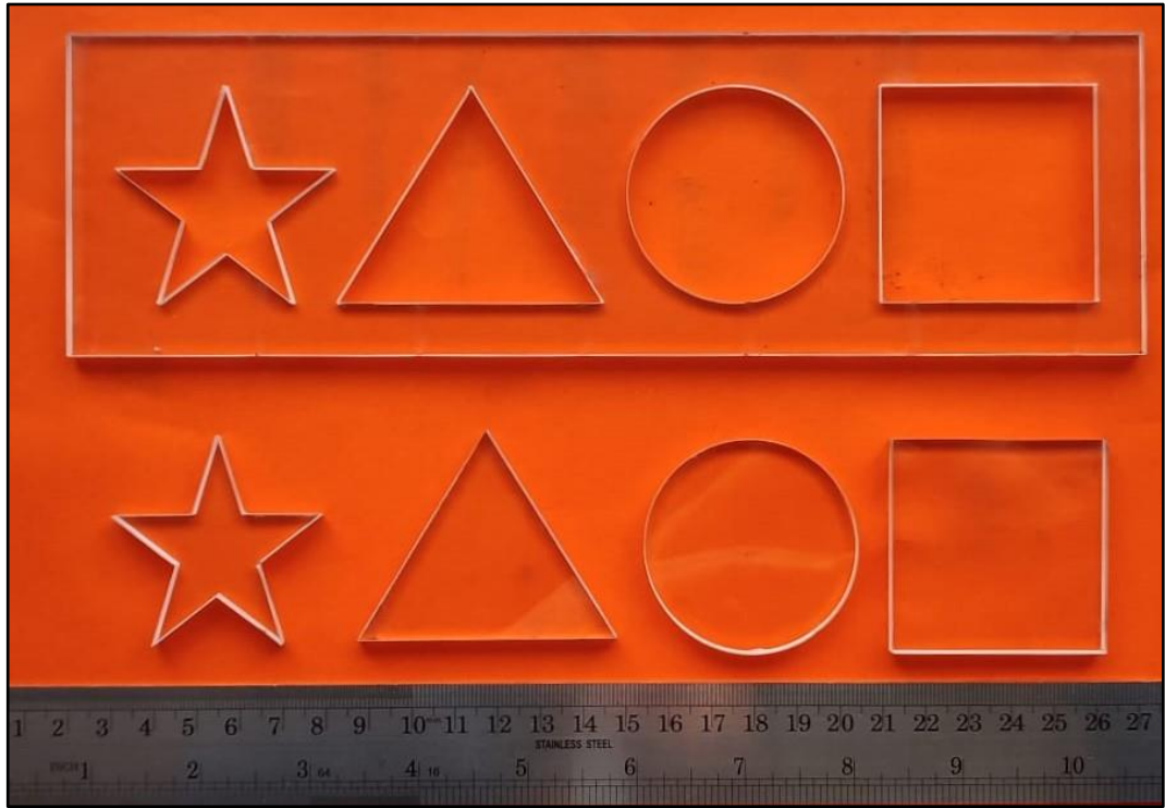
Şekil 5.7. Pleksi malzeme geometrik şekil kesim örneği.
