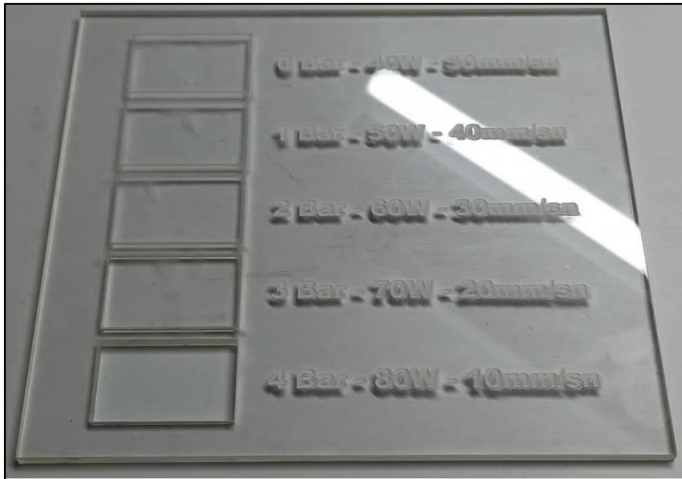
Şekil 5.6. Pleksi malzeme parametre çalışması.
