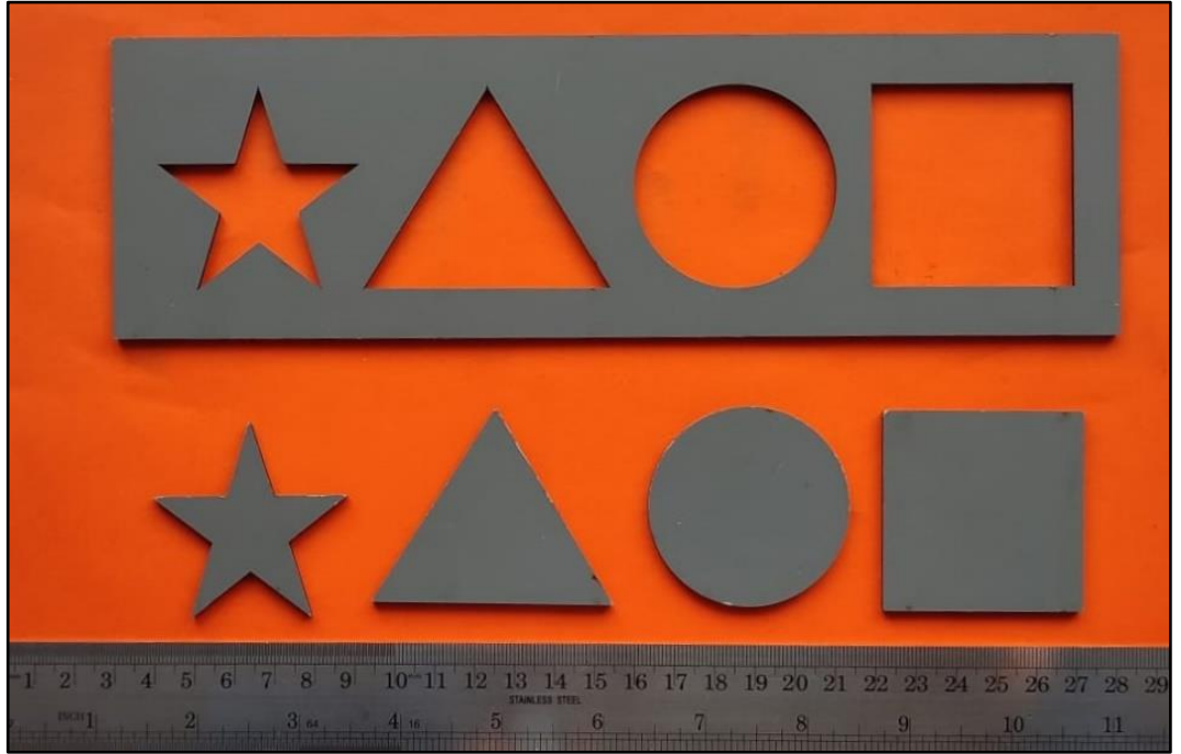
Şekil 5.5. MDF malzeme geometrik şekil kesim örneği.
