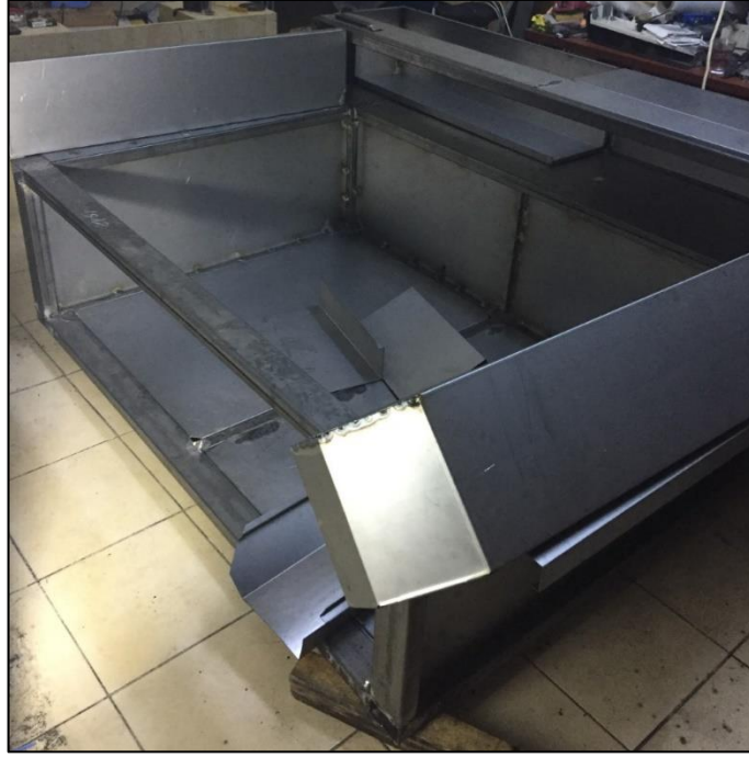
Şekil 4.2. Lazer makinesinin üst kısmının imalat aşamasından görüntü.
