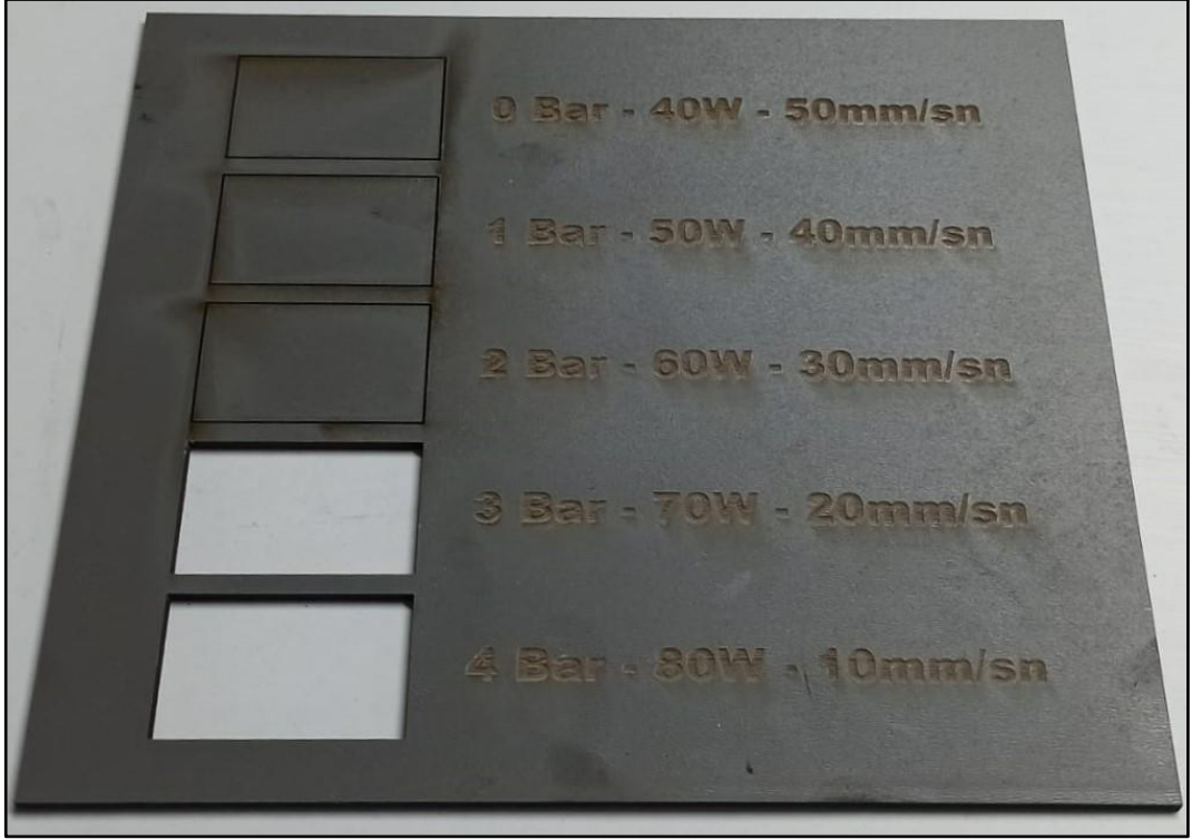
Şekil 5.3. MDF malzeme parametre çalışması.
