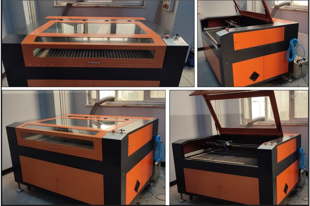
Şekil 4.21. Üretimi tamamlanan lazer makinesi.
