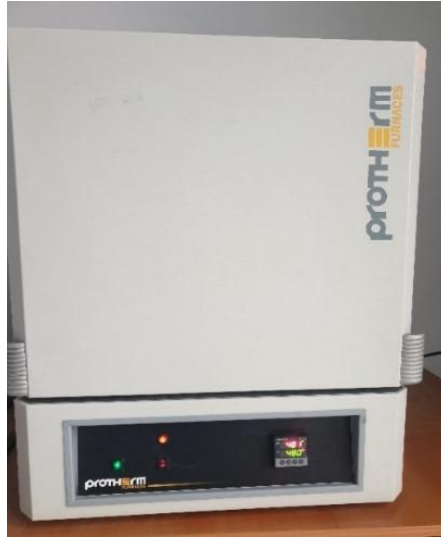
Şekil 6.3. Yaşlandırmada kullanılan ısıtım fırını.
