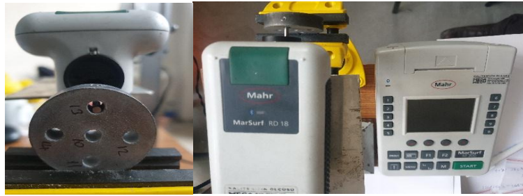
Şekil 6.8 Yüzey pürüzlülük ölçüm cihazı.
