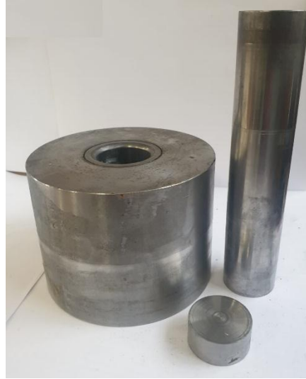
Şekil 6.1. Numune üretiminde kullanılan kalıp ve üretilen numune.
