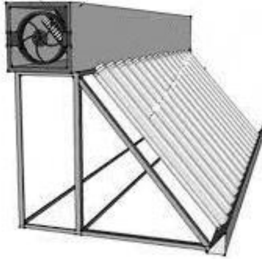
Şekil 3.2. Hava ısıtmada kullanılan vakum tüplü ısı borulu güneş kolektörü.
