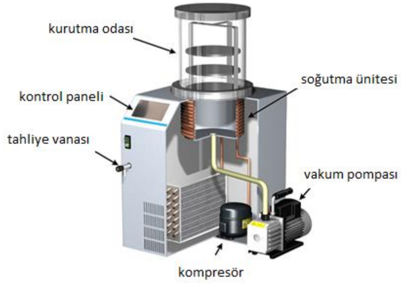
Şekil 6.2. Dondurarak kurutma cihazının şematik görünümü.
