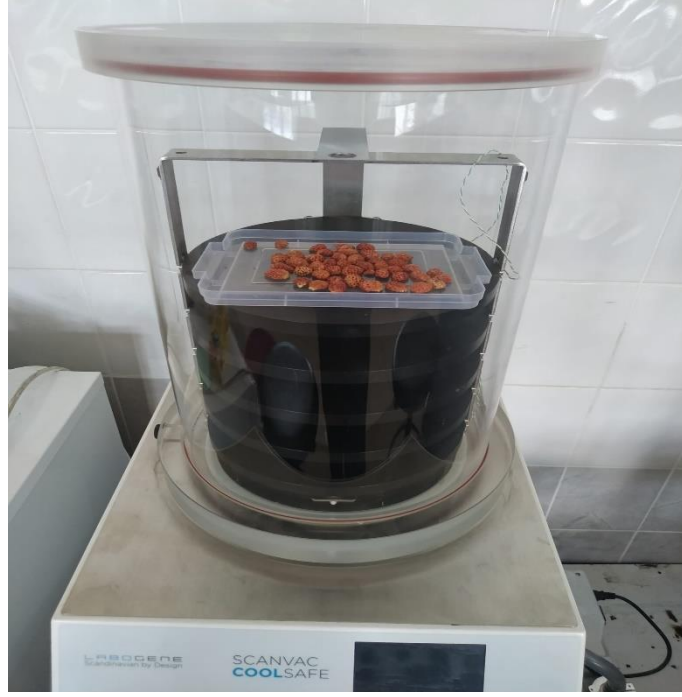
Şekil 6.4. Scanvac coolsafe marka dondurarak kurutma cihazında Osmanlı çileğinin kurutulması.
