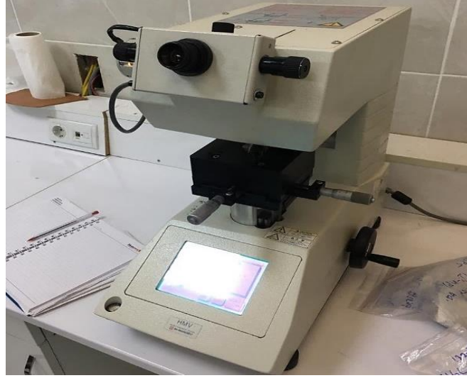
Şekil 4.2. Sertlik ölçüm cihazı.
