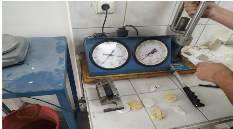
Şekil 5.19. Disk makaslama test düzeneği.
