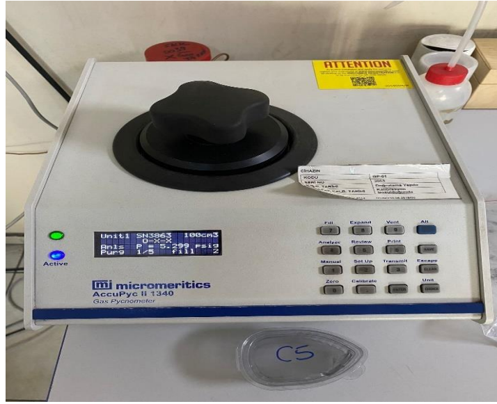
Şekil 5.15. ACCUPYC 2 1340 ile yapılan gerçek yoğunluk testleri.
