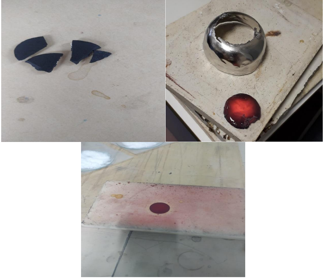
Şekil 5.10. Platin kroze ve magnezyum tabla ile testler
