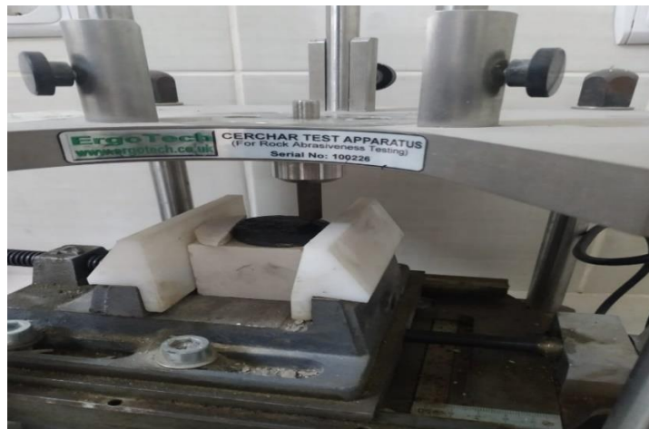
Şekil 5.24. Cherchar test düzeneği.
