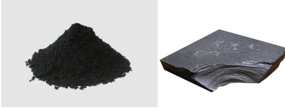
Şekil 2.3. Mikronize ve plaka bor karbür.
