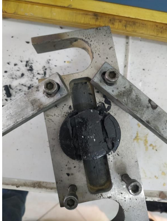
Şekil 5.21. Disk makaslama testi yapılmış numune.
