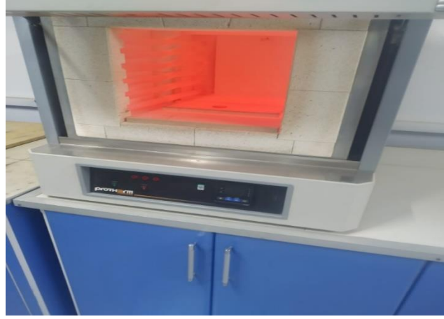
Şekil 5.8. Numunelerin beslendiği kül fırını.
