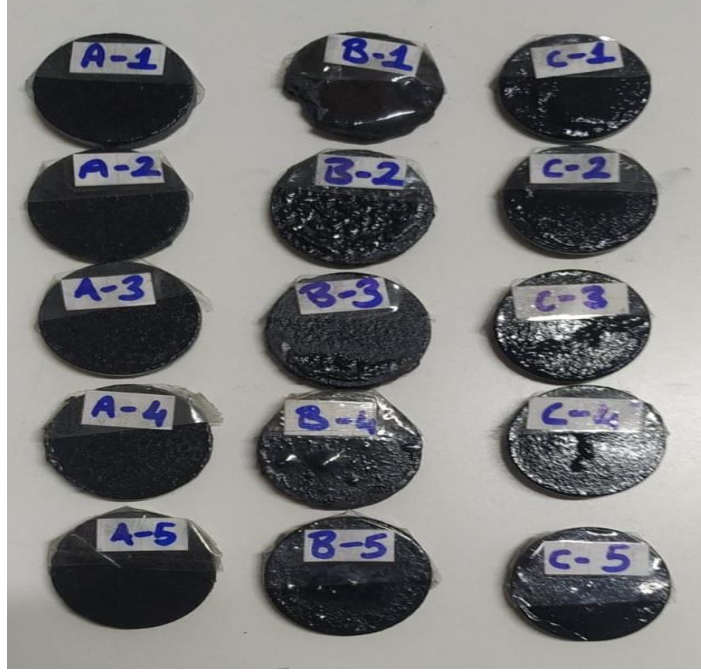
Şekil 5.11. Sinterlenmiş numunelerin makro görüntüleri.
