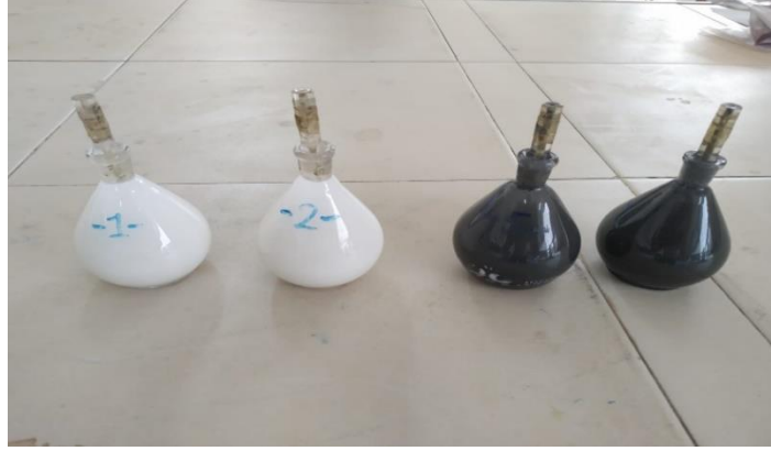
Şekil 5.13. Piknometre ile yapılan yoğunluk testleri.
