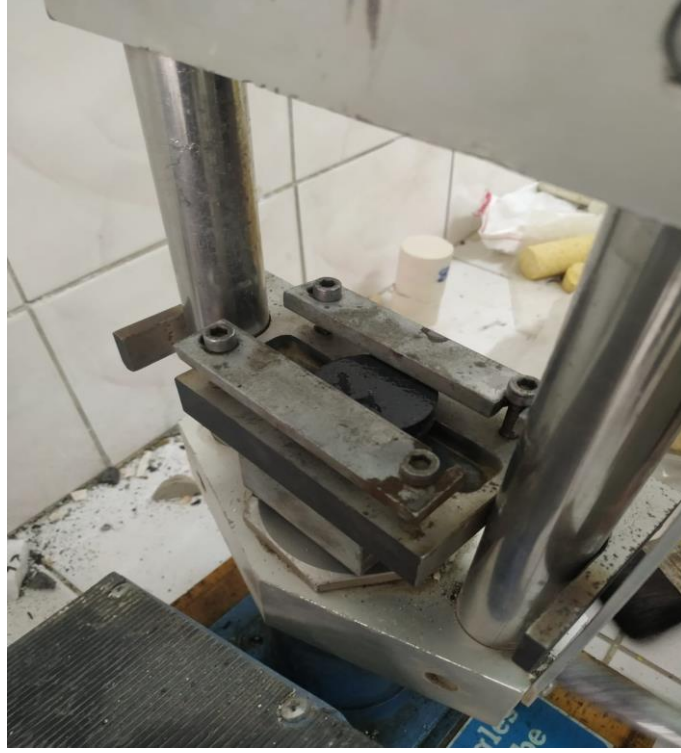
Şekil 5. 20. Disk makaslama test düzeneğine yerleştirilmiş kompozit numune.
