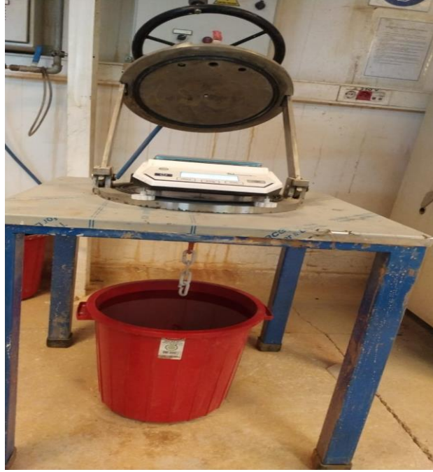
Şekil 5.17. Yerinde yoğunluk test düzeneği.
