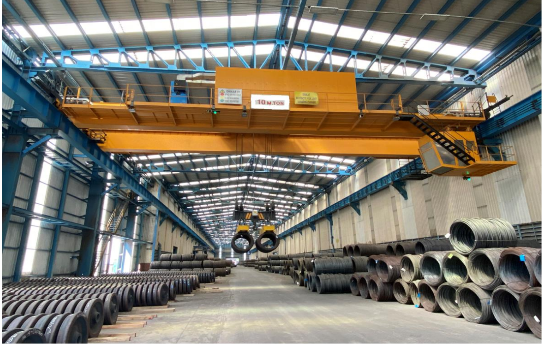
Şekil 6.4. Manyetik kaldırma aparatı entegreli gezer köprülü tavan vinci görseli.
